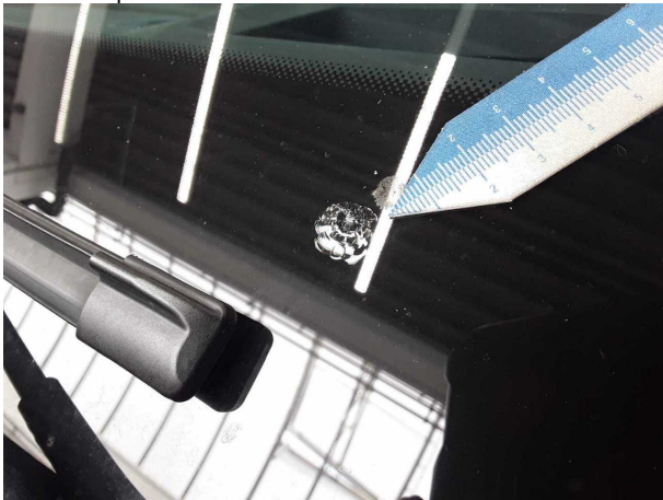
Beschädigung #4: Verglasung: Frontscheibe (Rissbildung) - Steinschlag - erneuern
