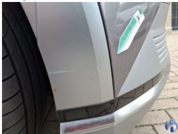
1. Stoßfänger Vorne Kratzer - Smart Repair
