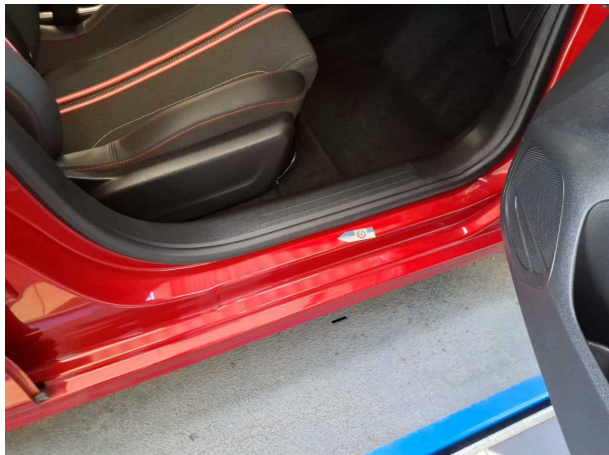
Beschädigung #1: Schweller rechts: Einstieg - Kratzer - auslegen / polieren
