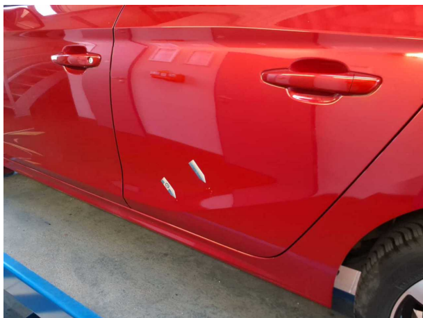
Beschädigung #6: Tür hinten links: Tür - Kratzer - lackieren
