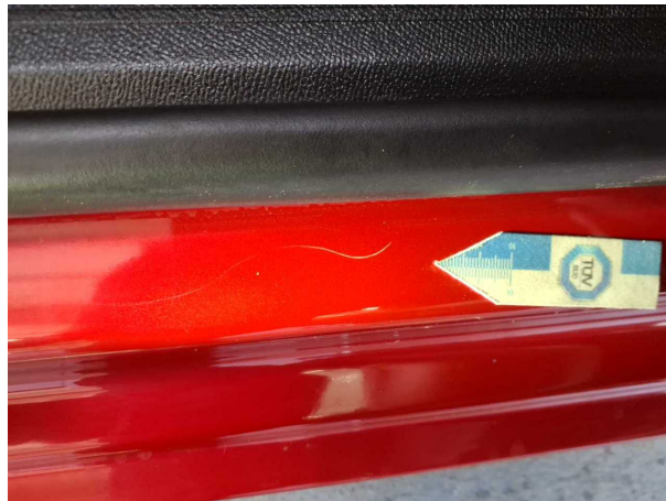
Beschädigung #1: Schweller rechts: Einstieg - Kratzer - auslege... polieren
