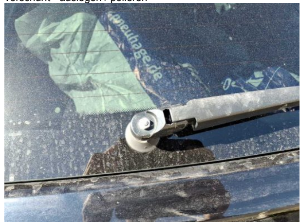
Beschädigung #4: Scheibenreinigung: Scheibenwischerarm hinten (Verkleidung fehlt) - erneuern
