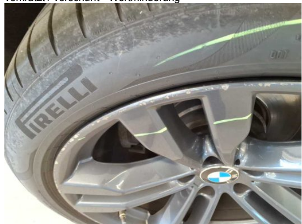
Beschädigung #16: Rad/Reifen: Leichtmetallfelge hinten rechts - verkratzt / verschürft - Wertminderung
