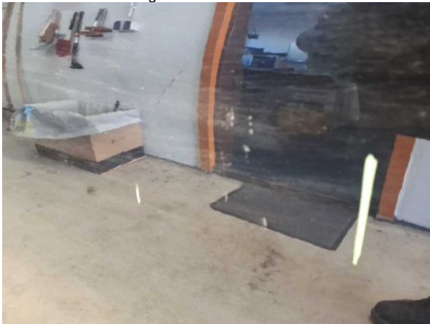
Beschädigung #2: Tür vorn links: Tür - Kratzer - auslegen / polieren
