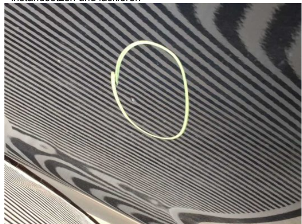
Beschädigung #20: Tür vorn rechts: Tür - verkratzt / verschü... - instandsetzen und lackieren
