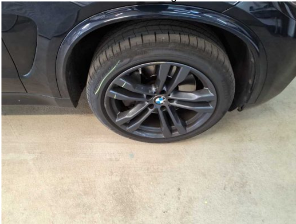
Beschädigung #15: Rad/Reifen: Leichtmetallfelge vorn rechts - verkratzt / verschürft - Wertminderung
