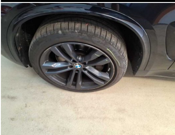
Beschädigung #14: Rad/Reifen: Leichtmetallfelge vorn links - verkratzt / verschürft - Wertminderung
