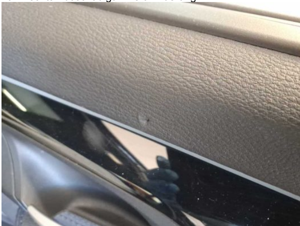
Beschädigung #10: Verkleidungen/Abdeckungen: Türverkleidung hinten rechts - verkratzt / verschürft - Wertminderung
