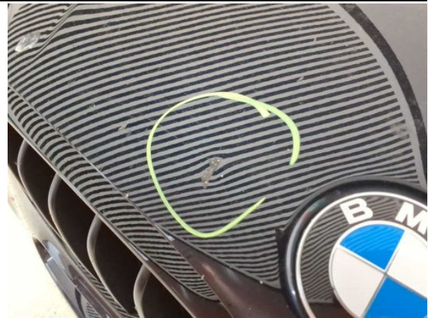
Beschädigung #21: Motorhaube: Motorhaube - Delle / Lackschaden - instandsetzen und lackieren
