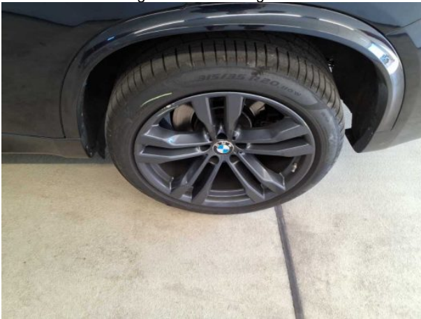
Beschädigung #12: Rad/Reifen: Leichtmetallfelge hinten links - verkratzt / verschürft - Wertminderung
