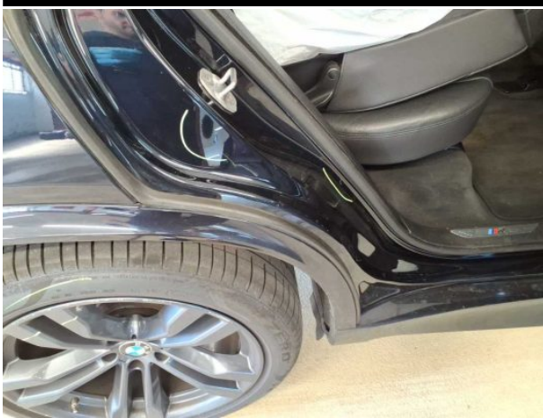
Beschädigung #17: Seitenwand rechts: Einstieg - verkratzt / verschürft - Smart Repair
