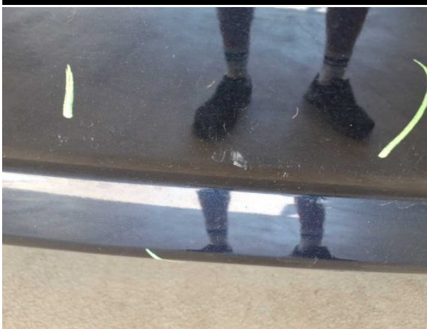
Beschädigung #19: Stossfänger hinten: Stossfänger hinten - verkratzt / verschürft - instandsetzen und lackieren
