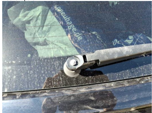
Damage #4: Screen cleaning: Wiper arm - rear (Verkleidung fehlt) - Replace
