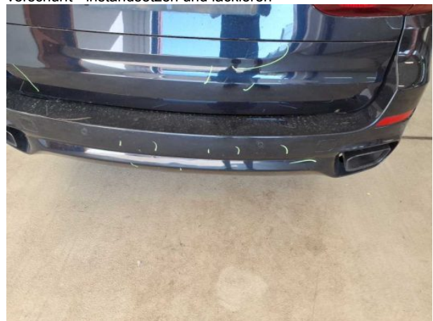
Beschädigung #19: Stossfänger hinten: Stossfänger hinten - verkratzt / verschürft - instandsetzen und lackieren
