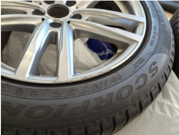
Beschädigung #1: 2.Radsatz: 1 Leichtmetallfelge - verkratzt / verschürft - kein Abzug
