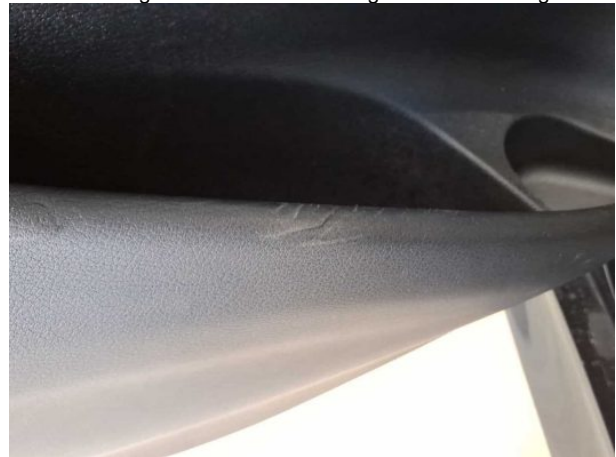
Beschädigung #7: Verkleidungen/Abdeckungen: Türverkleidung hinten links - beschädigt - Wertminderung
