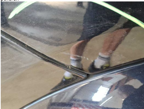
Beschädigung #3: Seitenwand rechts: Seitenwand - verkratzt / verschürft - auslegen / polieren
