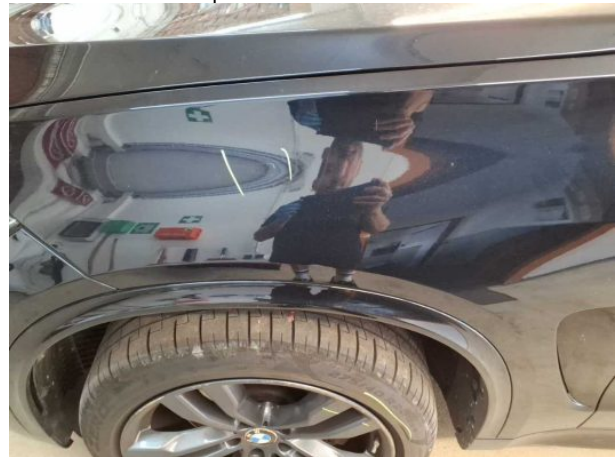
Beschädigung #18: Kotflügel links: Kotflügel links - verkratzt / verschürft - instandsetzen und lackieren
