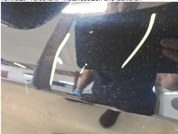
Beschädigung #20: Tür vorn rechts: Tür - verkratzt / verschürft - instandsetzen und lackieren
