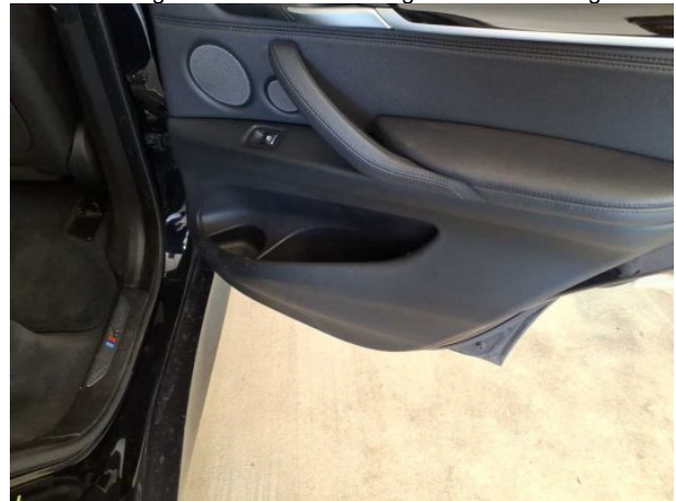
Beschädigung #10: Verkleidungen/Abdeckungen: Türverkleidung hinten rechts - verkratzt / verschürft -
