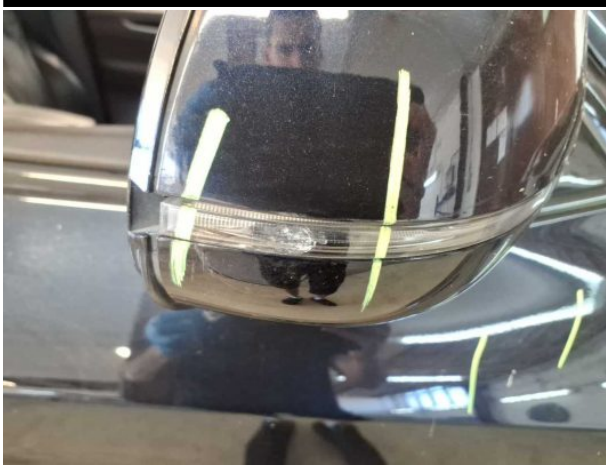
Beschädigung #5: Blinkleuchte: Spiegel rechts - verkratzt / verschürft - erneuern
