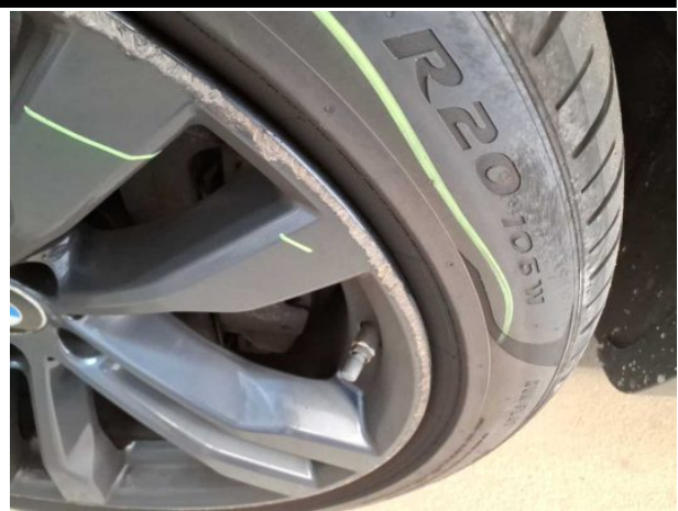
Beschädigung #14: Rad/Reifen: Leichtmetallfelge vorn links - verkratzt / verschürft - Wertminderung
