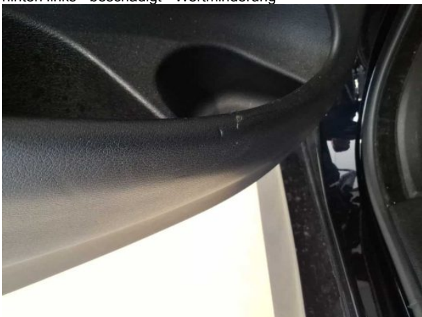
Beschädigung #7: Verkleidungen/Abdeckungen: Türverkleidung hinten links - beschädigt - Wertminderung
