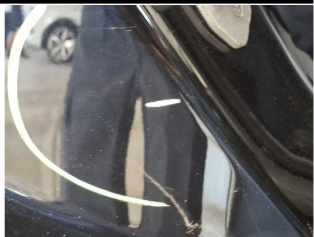
Beschädigung #17: Seitenwand rechts: Einstieg - verkratzt / verschürft - Smart Repair
