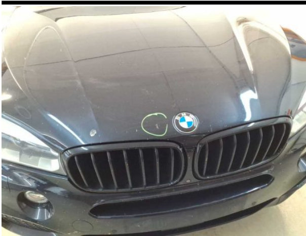
Beschädigung #21: Motorhaube: Motorhaube - Delle / Lackschaden - instandsetzen und lackieren
