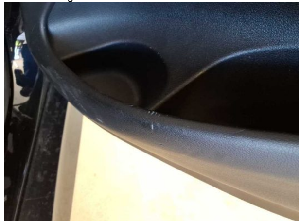
Beschädigung #10: Verkleidungen/Abdeckungen: Türverkleidung hinten rechts - verkratzt / verschürft -
