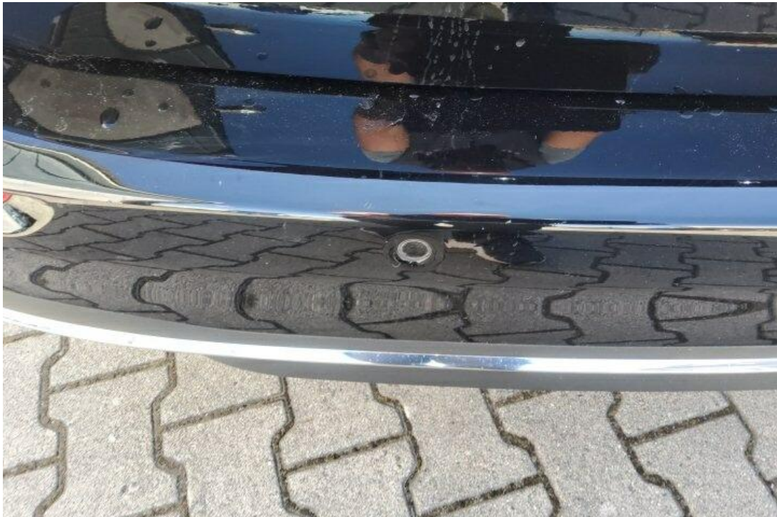
Bild 1 : Heckschürze hinten unten Lackierung, zerkratzt, Gebrauchsspur
