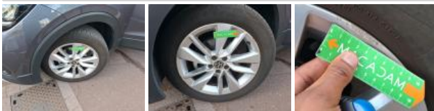
Alloy rim FL, Scratch(es), Repair/replace (lump sum)
