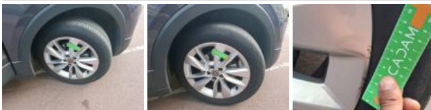
Alloy rim FR, Scratch(es), Repair/replace (lump sum)
