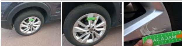
Alloy rim RR, Scratch(es), Repair/replace (lump sum)
