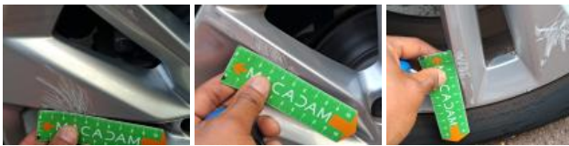
Alloy rim FR, Scratch(es), Repair/replace (lump sum)
