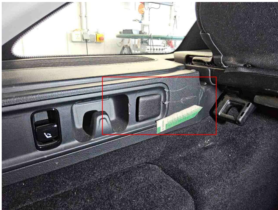
Bild 15 : Innenverkleidung Kofferraum verschrammt
