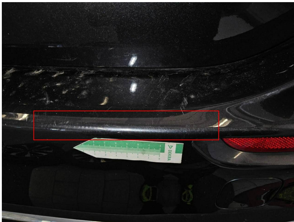
Bild 30 : Stoßfänger hinten, verschrammt, lackieren mit Lackaufbau
