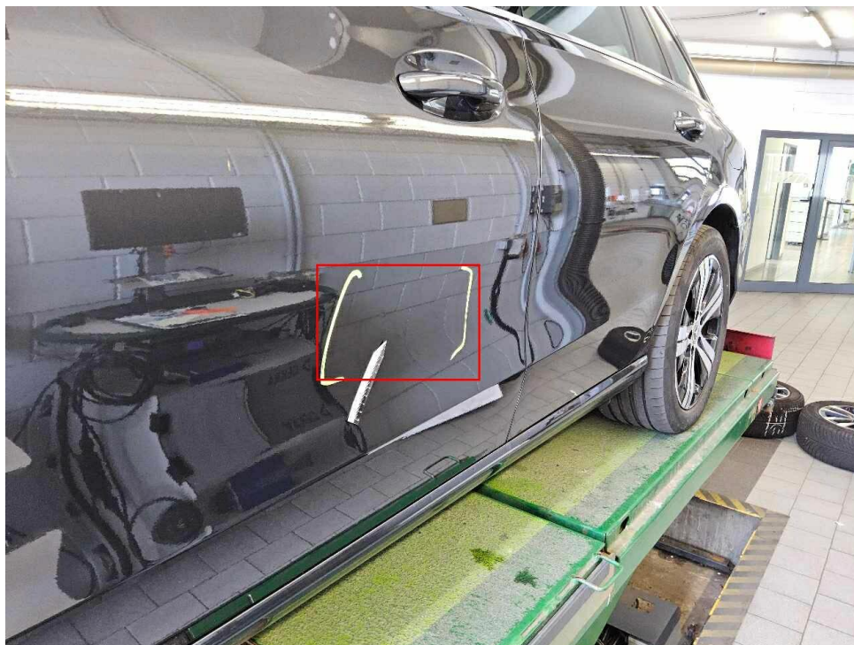
Bild 23 : Tür vorne links eingedellt, verschrammt
