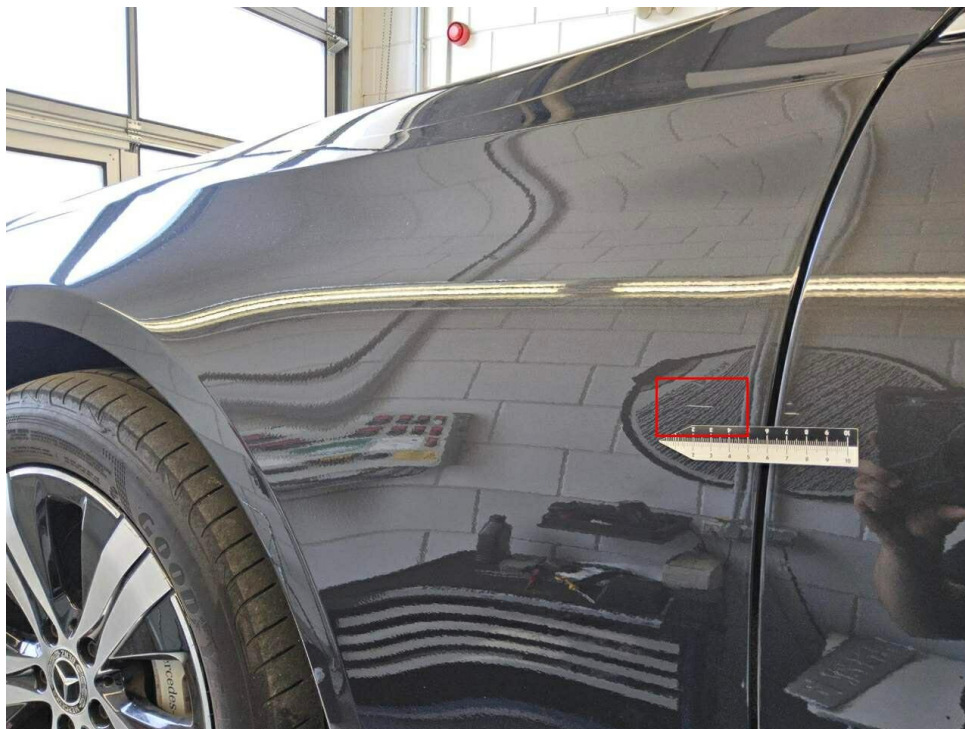
Bild 27 : Kotflügel vorne links Lackierung, zerkratzt, lackieren mit Lackaufbau
