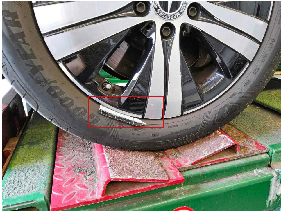
Bild 19 : Sommerfelge (glanzgedreht) vorne links verschrammt
