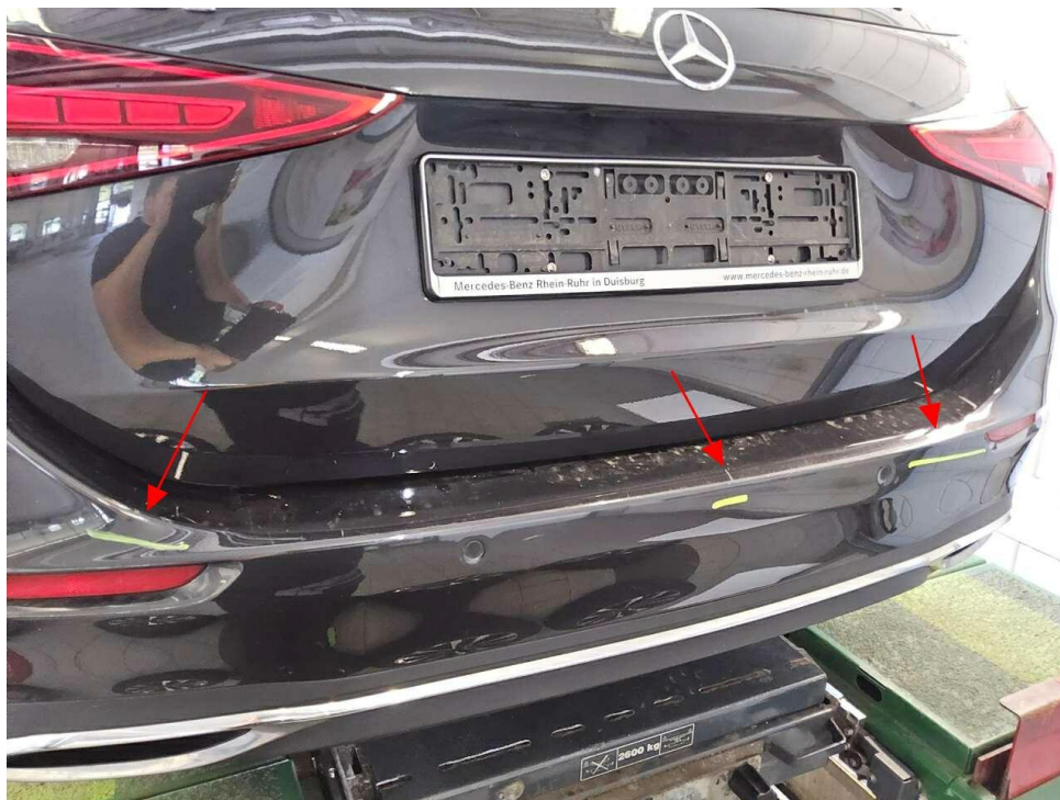
Bild 29 : Stoßfänger hinten, verschrammt, lackieren mit Lackaufbau
