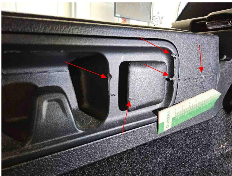
Bild 16 : Innenverkleidung Kofferraum verschrammt
