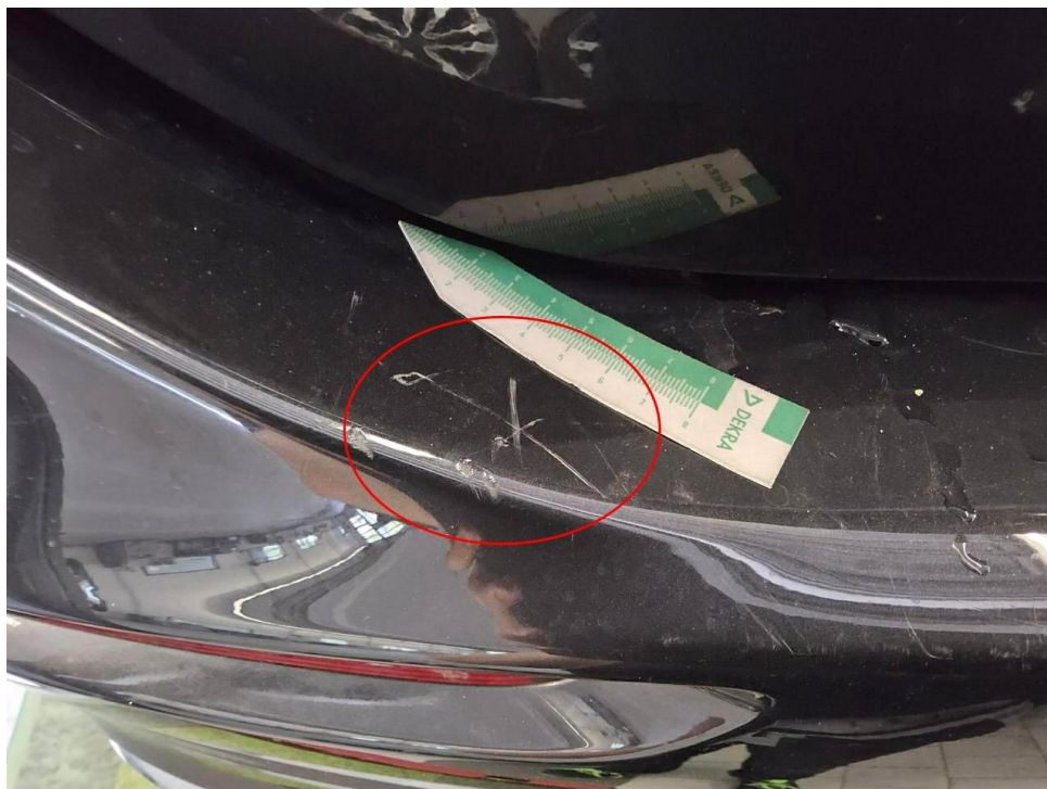
Bild 32 : Stoßfänger hinten, verschrammt, lackieren mit Lackaufbau
