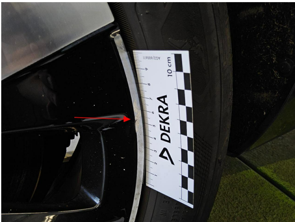
Bild 22 : Sommerfelge (glanzgedreht) hinten links verschrammt
