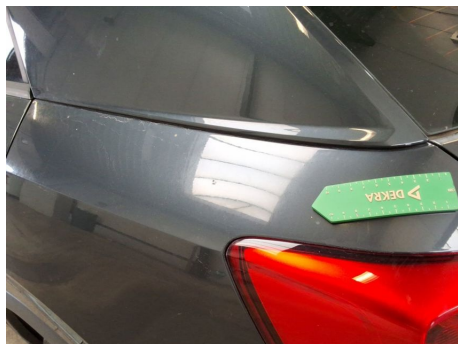
Exterieur compleet / Buitenkant Buitenkant / Chemische inwerking
