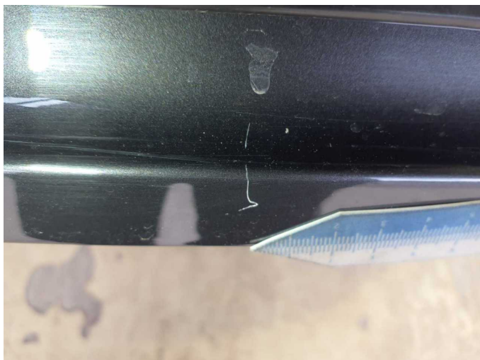
Damage 12: Boot lid / rear door: Boot lid - Scratch(es) - Paint
