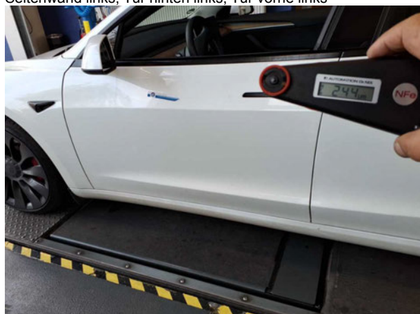
Nacklackierung 1: Kotflügel links, Kotflügel rechts, Motorhaube, Seitenwand links, Tür hinten links, Tür vorne links
