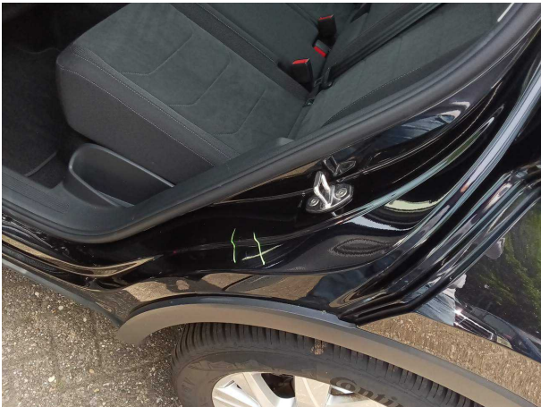
Beschädigung #2: Seitenwand links: Einstieg - Kratzer - Smart Repair
