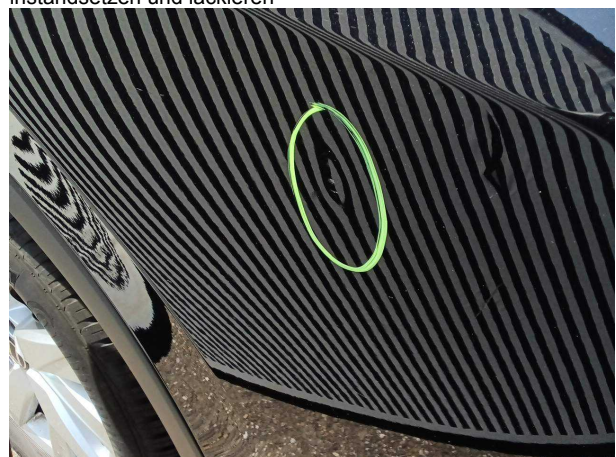
Beschädigung #5: Tür hinten rechts: Tür - Delle / Lackschad... - instandsetzen und lackieren
