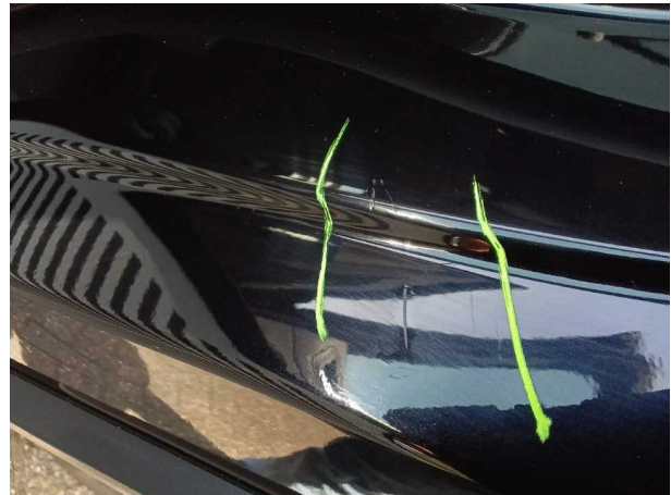
Beschädigung #2: Seitenwand links: Einstieg - Kratzer - Sm... Repair
