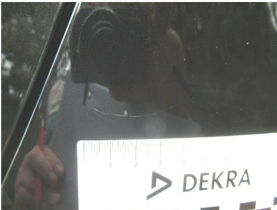
Bild 15 : Seitenwand hinten links leichte Delle
