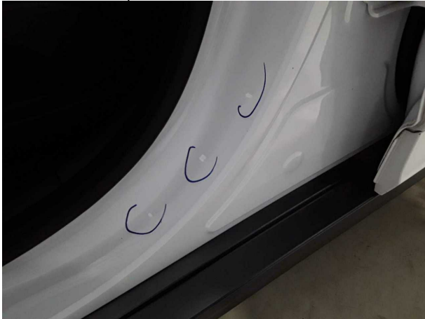
Beschädigung #4: Schweller links: Einstieg - Delle / Lackschade... sanft instandsetzen
