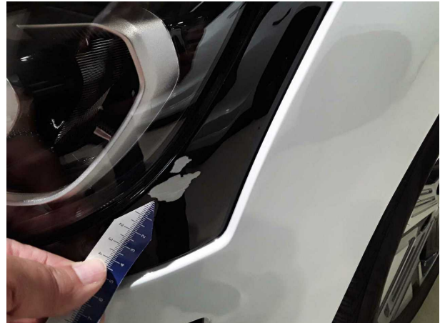
Beschädigung #1: Stossfänger vorn: Blende unter Scheinwerfer (Blende li. platzt Lack ab) - Lackmangel -
