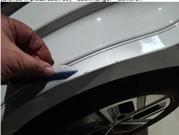
Beschädigung #2: Seitenwand links: Radlauf (Radlaufblende) - Kratzer - Smart Repair
