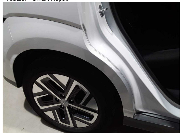
Beschädigung #3: Seitenwand rechts: Radlauf (Radlaufblende) - Kratzer - Smart Repair
