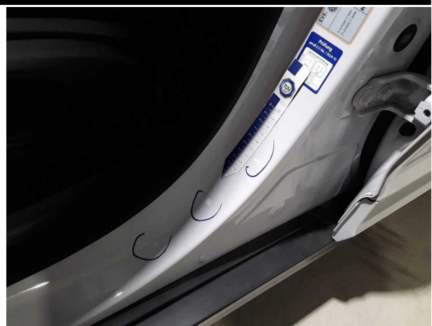
Beschädigung #4: Schweller links: Einstieg - Delle / Lackschaden - sanft instandsetzen
