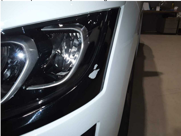
Beschädigung #1: Stossfänger vorn: Blende unter Scheinwerfer (Blende li. platzt Lack ab) - Lackmangel - lackieren
