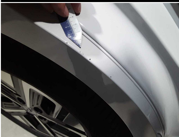
Beschädigung #3: Seitenwand rechts: Radlauf (Radlaufblende) - Kratzer - Smart Repair
