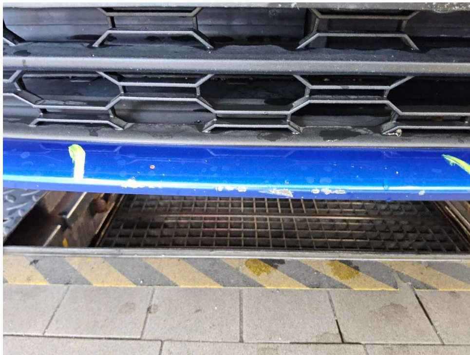
Bild 29 : Stoßfänger vorne rechts verschrammt
