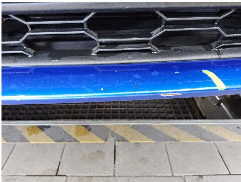
Bild 30 : Stoßfänger vorne rechts verschrammt
