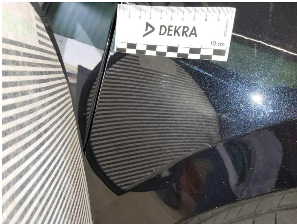
Bild 25 : Kotflügel vorne rechts Lackierung, zerkratzt, smart repair
