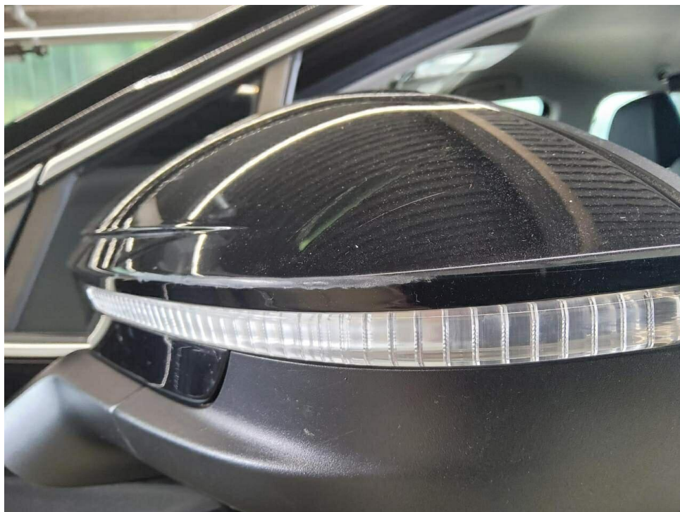
Bild 18 : Außenspiegel links Lackierung, zerkratzt, smart repair
