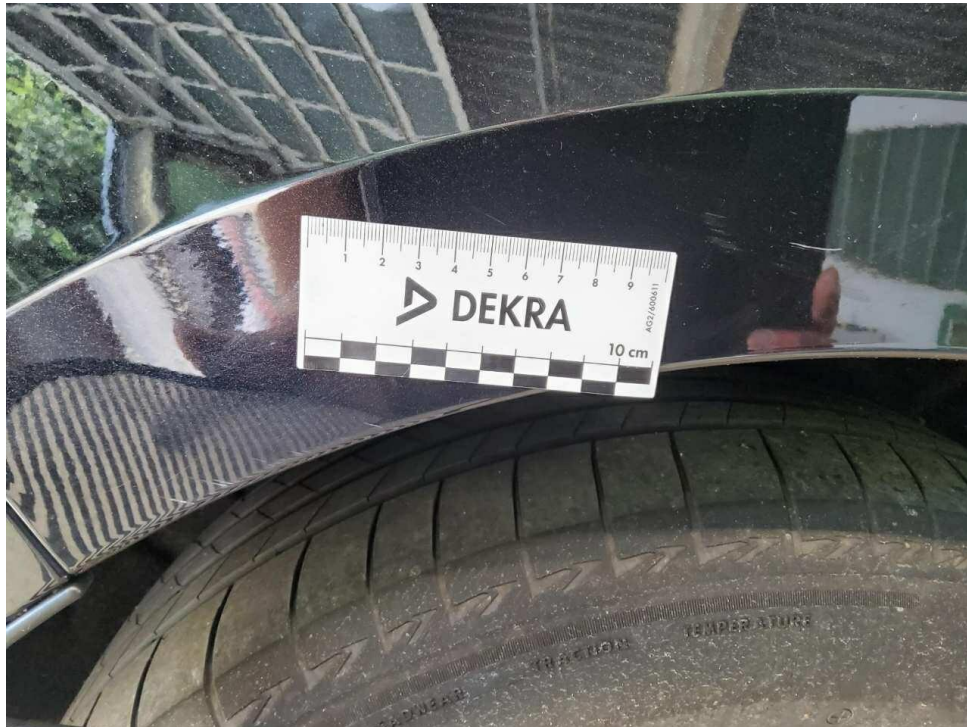
Bild 23 : Seitenteil hinten rechts Lackierung, zerkratzt, smart repair
