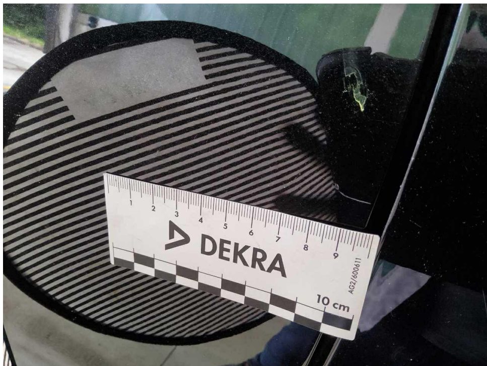
Bild 24 : Tür hinten rechts Lackierung, zerkratzt, smart repair
