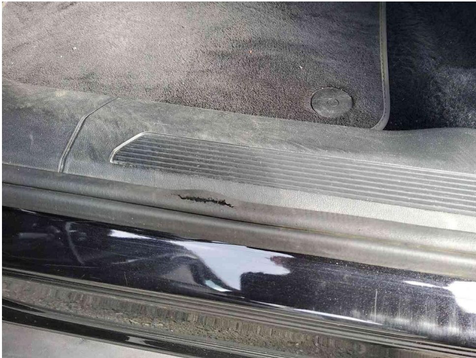
Bild 15 : Dichtung Fahrertür gerissen
