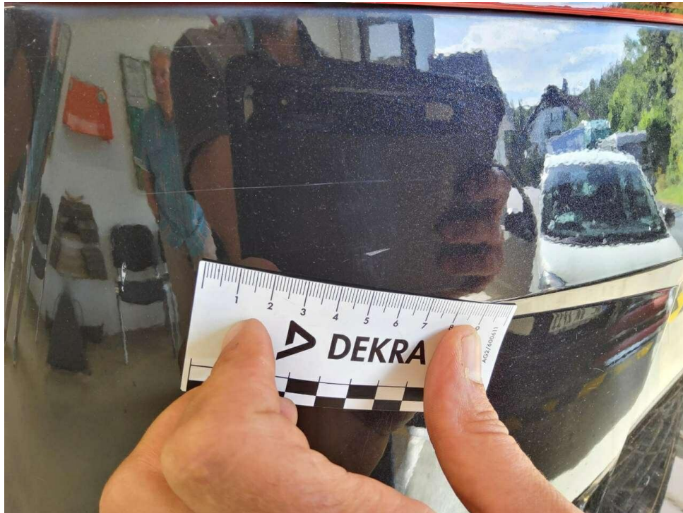
Bild 21 : Stoßfänger hinten Lackierung, zerkratzt, lackieren mit Lackaufbau
