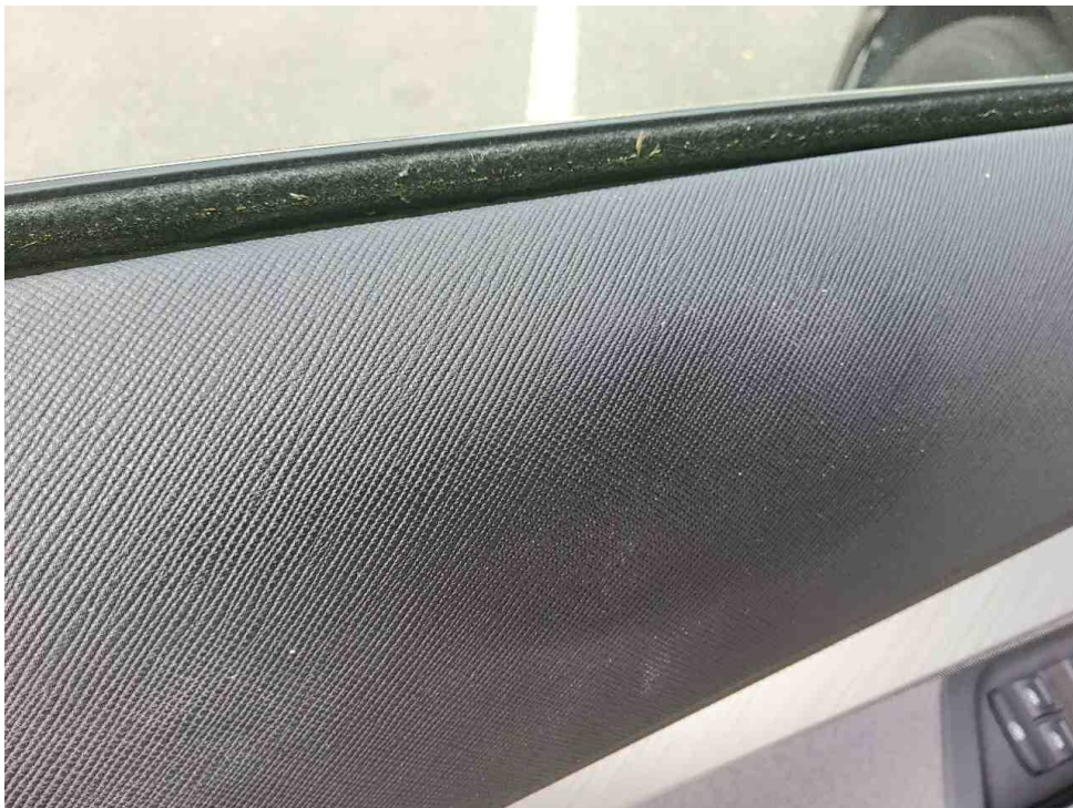
Bild 16 : Türverkleidung Fahrertür Anhaftung
