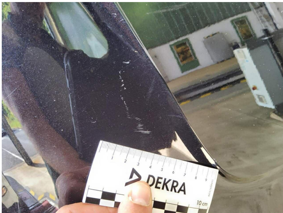
Bild 22 : Stoßfänger hinten Lackierung, zerkratzt, lackieren mit Lackaufbau
