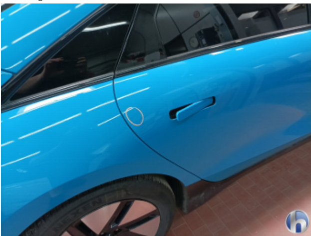
1. Tür Hinten - Rechts Delle - Smart Repair
