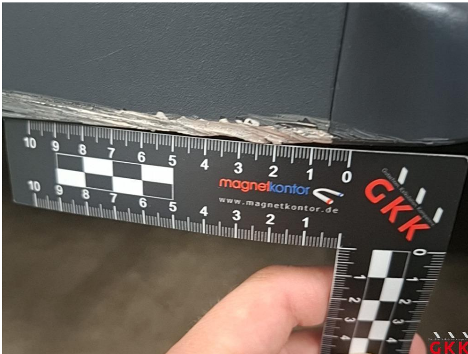
Bild 31 Trittbrett links, beschädigt, ersetzen
