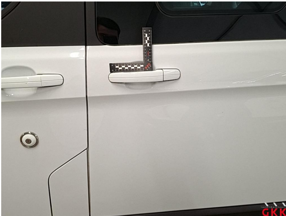
Bild 33 Schiebetür links, Griff, verkratzt, lackieren ohne LV
