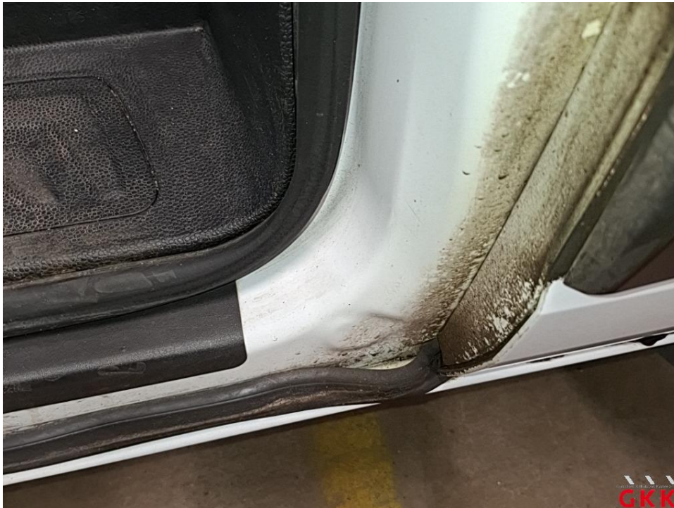
Bild 21 Tür vorne links, Dichtung -Einstieg-, lose, ersetzen
