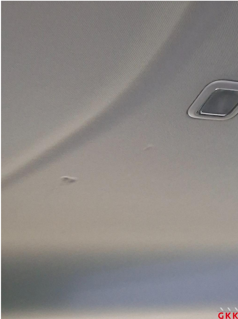
Bild 23 Himmel, Druckstellen, Smartrepair
