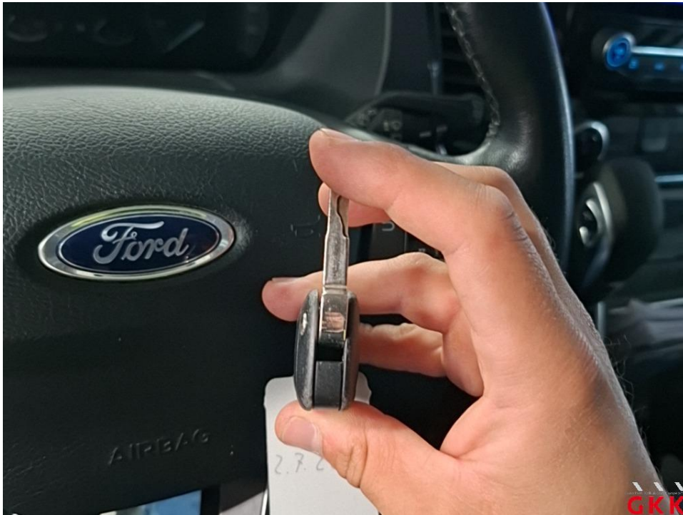
Bild 17 Hauptschlüssel, mit Fernbedienung, beschädigt, ersetzen
