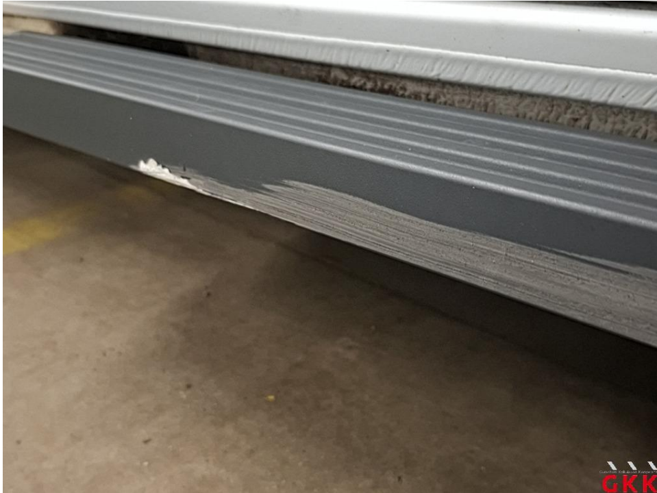
Bild 32 Trittbrett links, beschädigt, ersetzen
