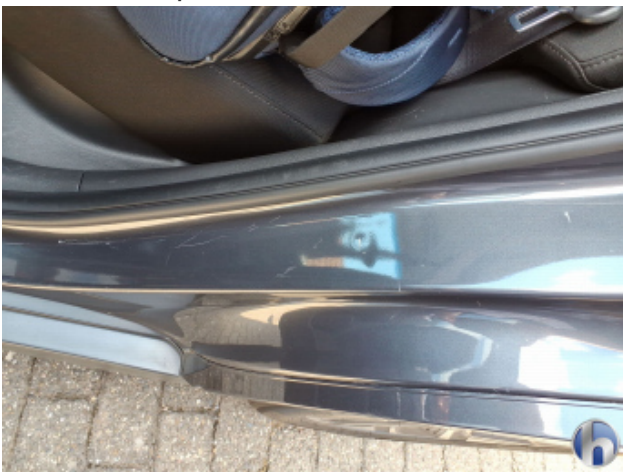
8. Fußraum Innenraum rechts vorne Kratzer - Smart Repair
