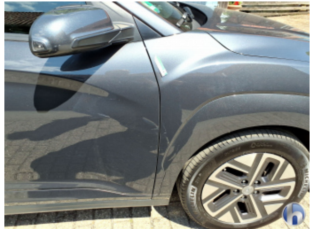
4. Kotflügel Vorne - Rechts Kratzer - Lackieren
