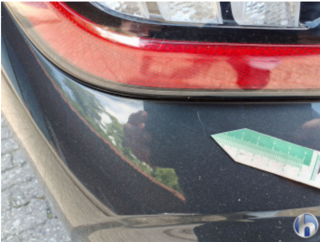
2. Stoßfänger Hinten Kratzer - Lackieren
