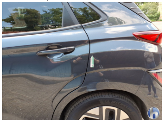
6. Seitenwand - Hinten - Links Kratzer - Smart Repair
