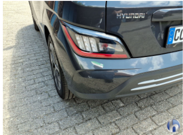
2. Stoßfänger Hinten Kratzer - Lackieren
