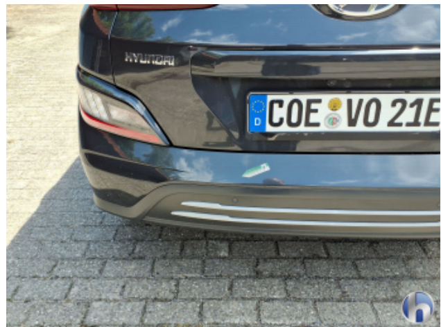
2. Stoßfänger Hinten Kratzer - Lackieren
