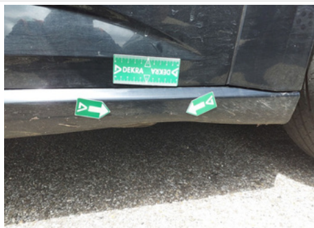
Bas de caisse / Avant Droit / Enfoncement
