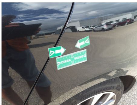
Aile / Arrière Gauche / Enfoncement
