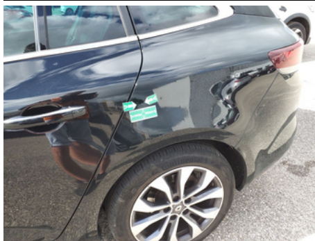
Aile / Arrière Gauche / Enfoncement
