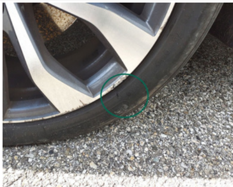
Pneu / Avant Gauche / Déchiré
