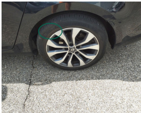
Pneu / Arrière Gauche / Déchiré
