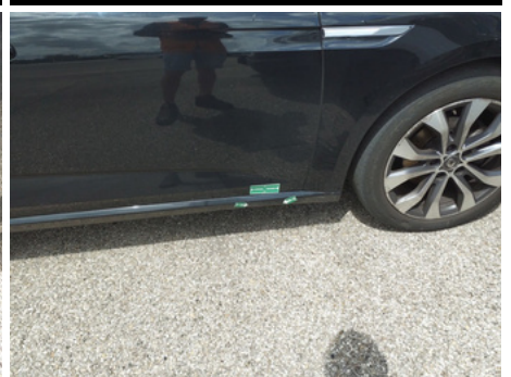
Bas de caisse / Avant Droit / Enfoncement
