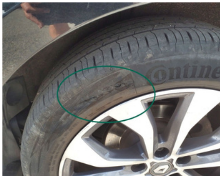
Pneu / Arrière Gauche / Déchiré
