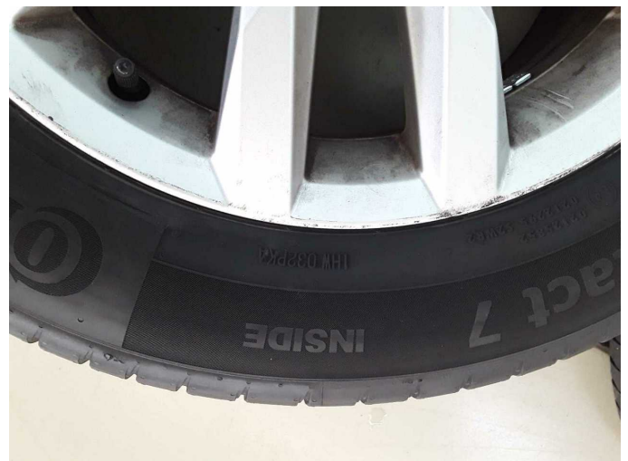
Damage 1: 2nd wheel set: 2 tyres (Inside steht Außen am Reifen) - Malposition - Un- / install
