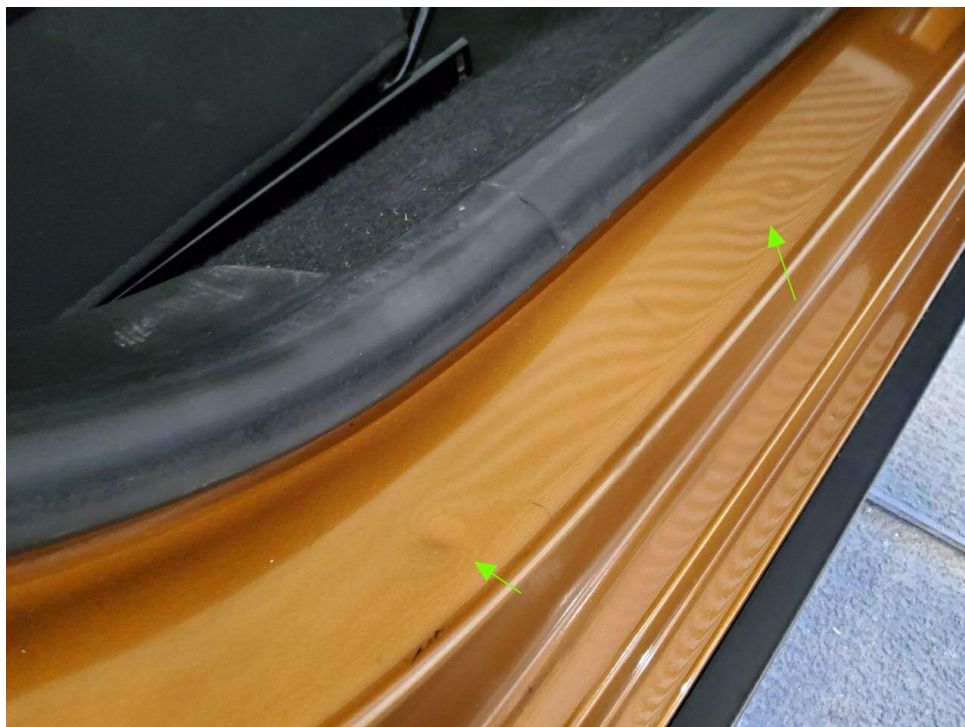
Bild 16 : Einstieg vorne rechts eingedellt
