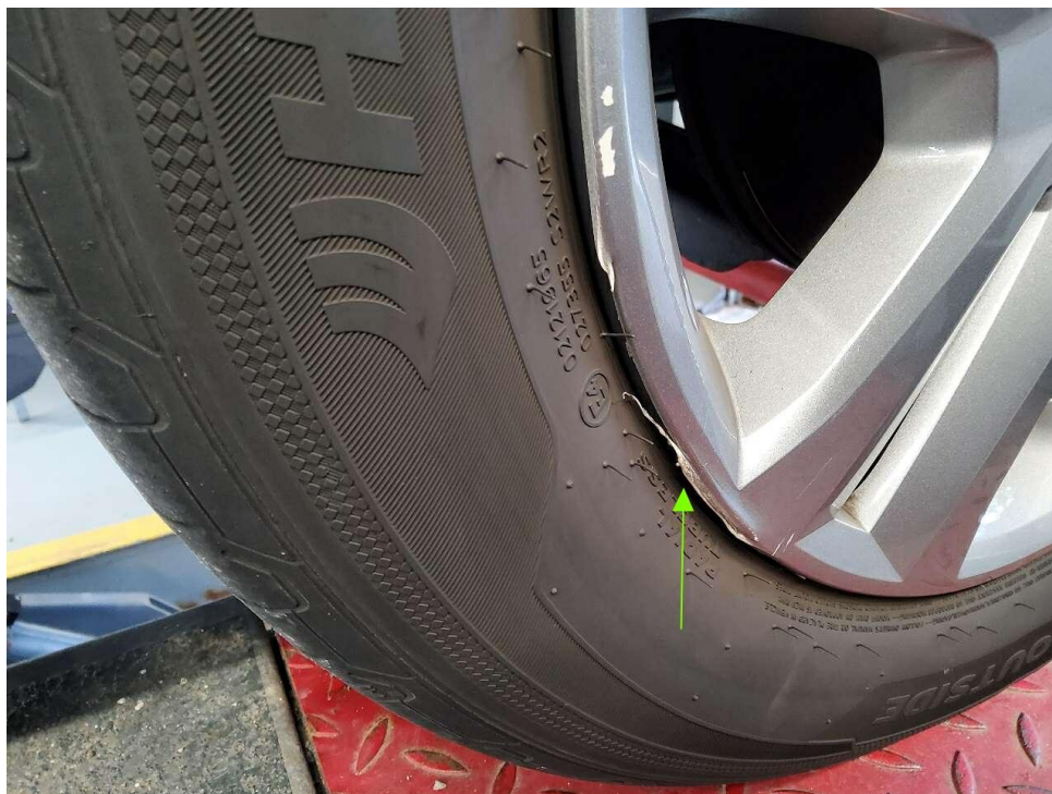
Bild 17 : Radzierblende vorne rechts gebrochen
