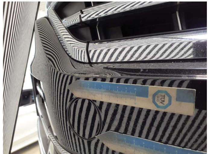
Damage 11: Front bumper: Front bumper (Zusätzlich Zierleiste mitte gebrochen) - Broken / torn - Replace
