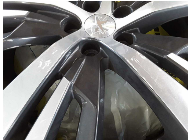
Beschädigung #7: 2.Radsatz: 3 Leichtmetallfelgen - verkratzt... verschürft - Wertminderung
