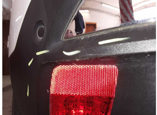
Beschädigung #3: Stossfänger hinten: Spoiler - verkratzt / verschürft - Wertminderung
