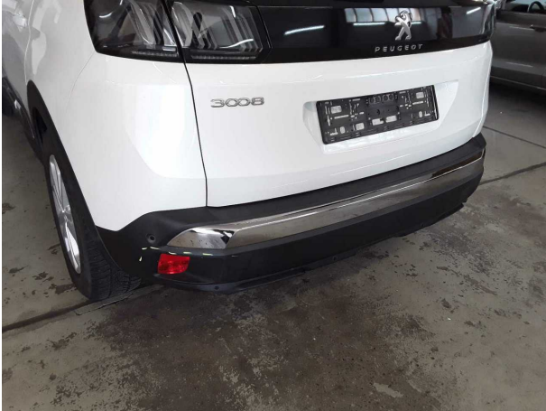
Beschädigung #3: Stossfänger hinten: Spoiler - verkratzt / verschürft - Wertminderung
