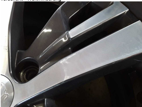
Beschädigung #7: 2.Radsatz: 3 Leichtmetallfelgen - verkratzt / verschürft - Wertminderung
