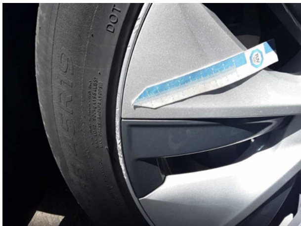
Beschädigung #1: Rad/Reifen: Leichtmetallfelge vorn rechts - beschädigt - erneuern
