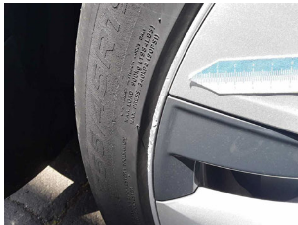
Beschädigung #1: Rad/Reifen: Leichtmetallfelge vorn rechts - beschädigt - erneuern
