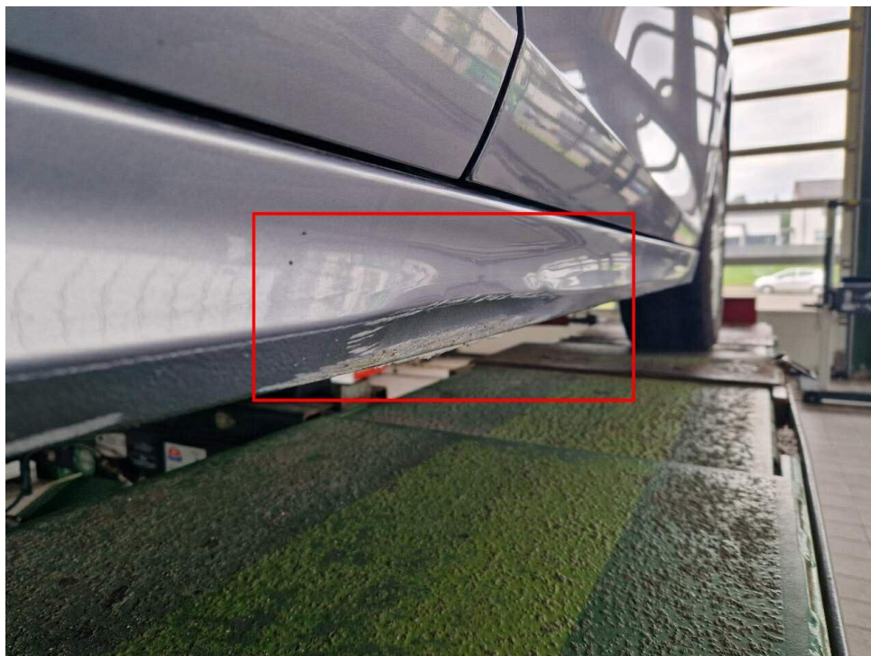
Bild 17 : Schweller rechts eingedrückt
