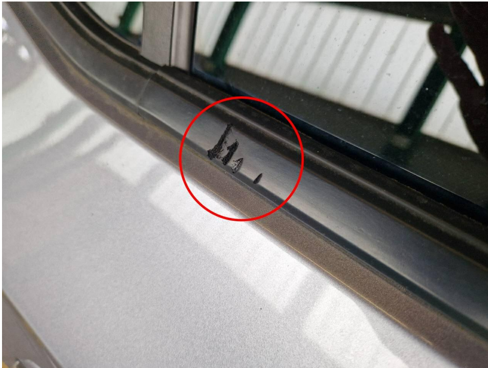
Bild 13 : Tür hinten rechts Schachtdichtung verschrammt
