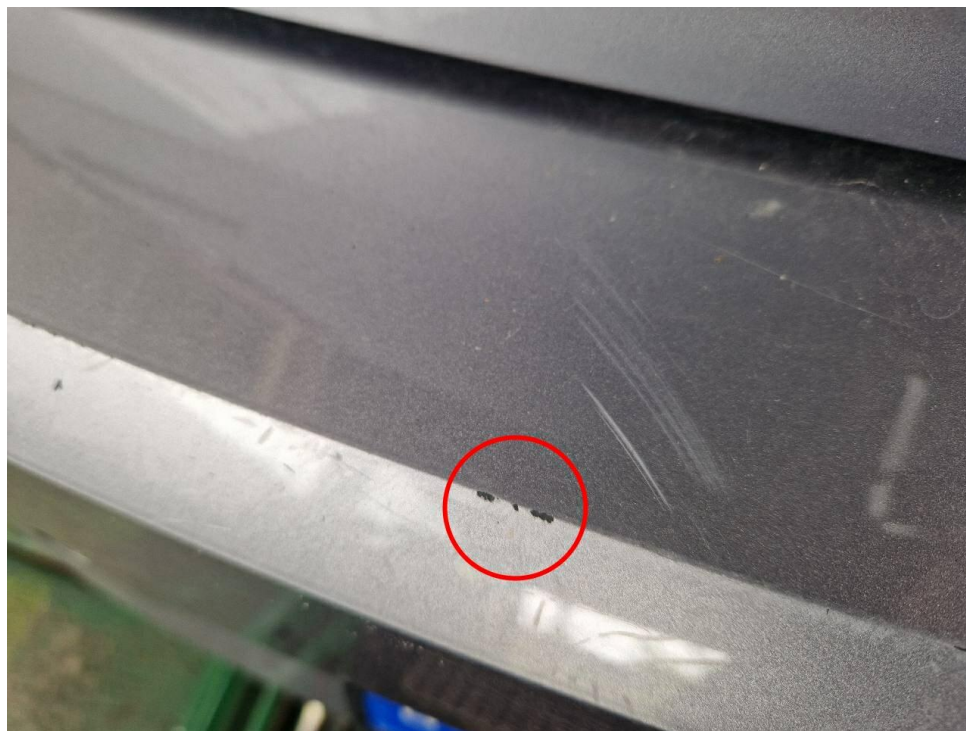
Bild 12 : Stossfänger hinten verschrammt
