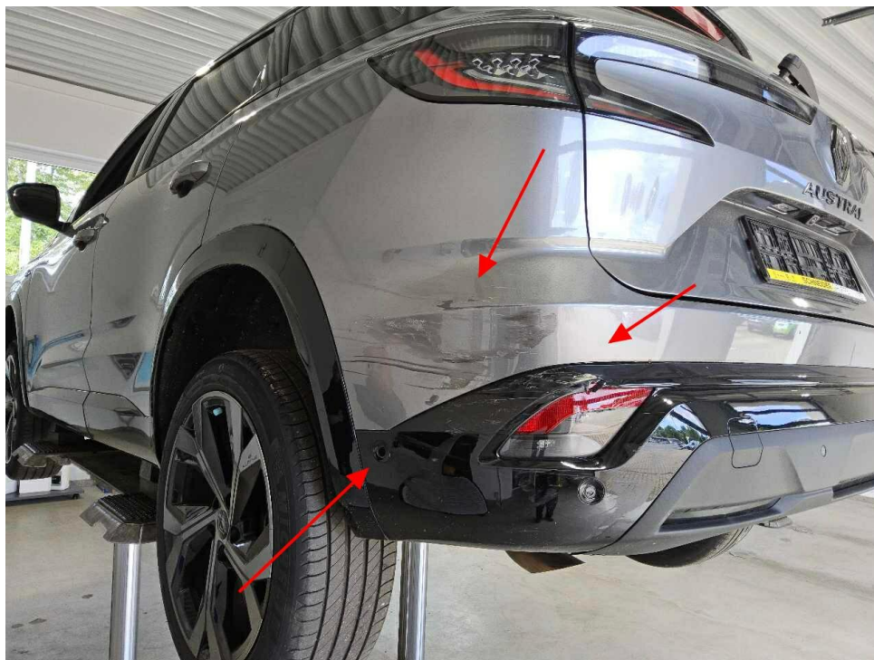
Bild 15 : Anfahrschaden hinten links
