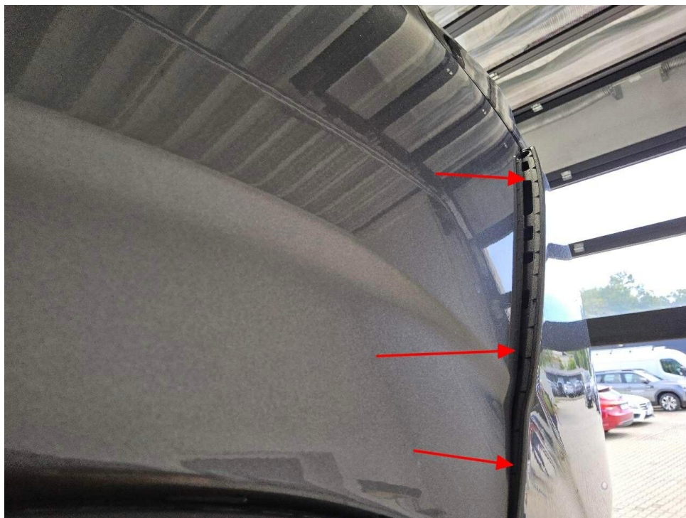
Bild 19 : Anfahrschaden hinten links
