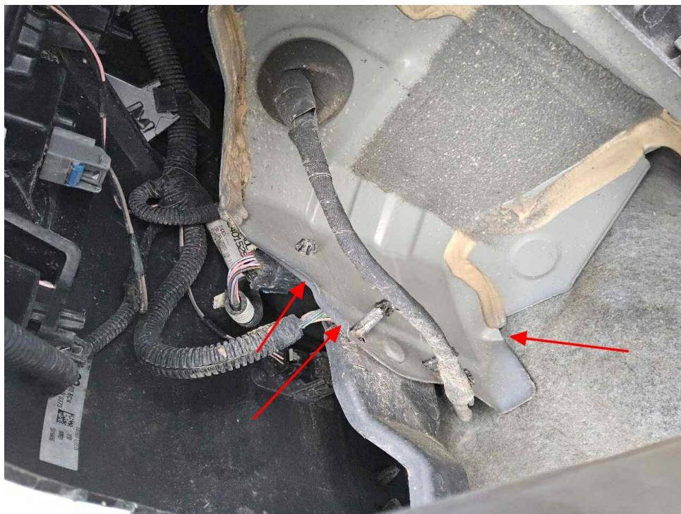
Bild 21 : Anfahrschaden hinten links
