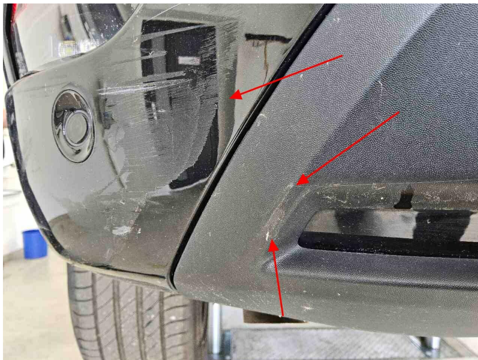
Bild 20 : Anfahrschaden hinten links
