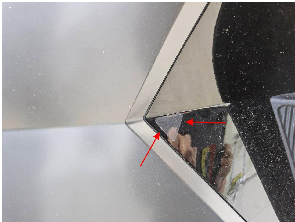
Bild 14 : Fahrzeug Beklebung entfernen, Polierversuch, Schadenerweiterung möglich
