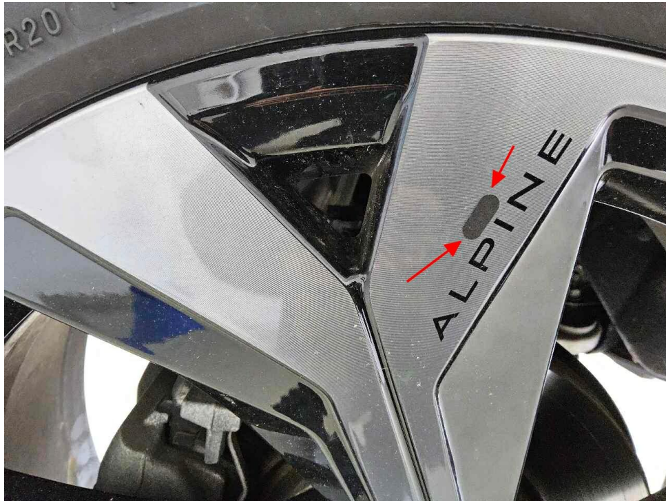
Bild 13 : Fahrzeug Beklebung entfernen, Polierversuch, Schadenerweiterung möglich
