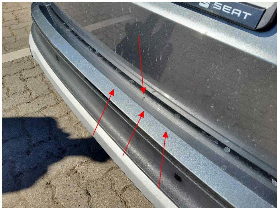
Bild 14 : Stoßfänger hinten, Lackierung zerkratzt
