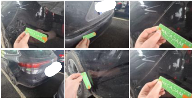
Moulure d'aile AVD, Manque, E - Remplacer
