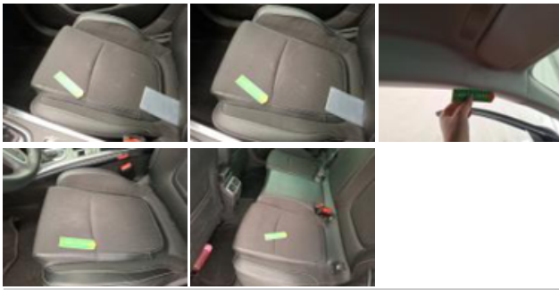
Revêtement assise siège AVG, Déchirure, Smart repair +
