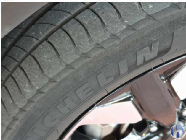
6. Reifen Vorne - Links Nicht Verkehrssicher - Erneuern
