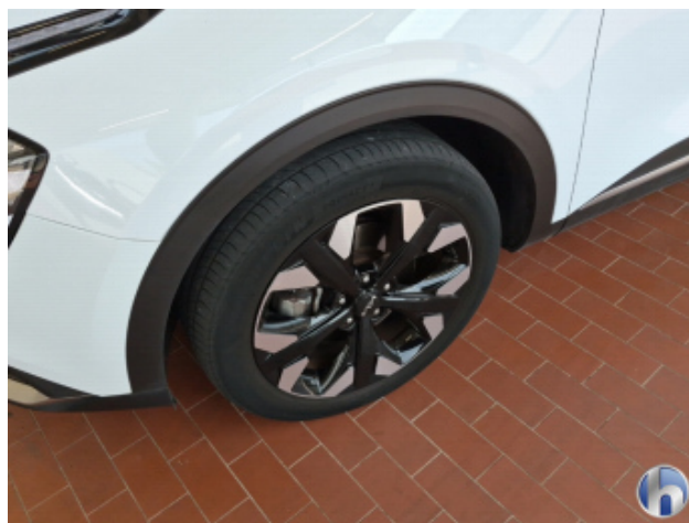
6. Reifen Vorne - Links Nicht Verkehrssicher - Erneuern
