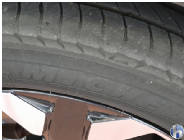
5. Reifen Vorne - Rechts Nicht Verkehrssicher - Erneuern
