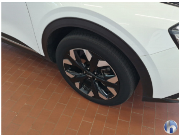
5. Reifen Vorne - Rechts Nicht Verkehrssicher - Erneuern
