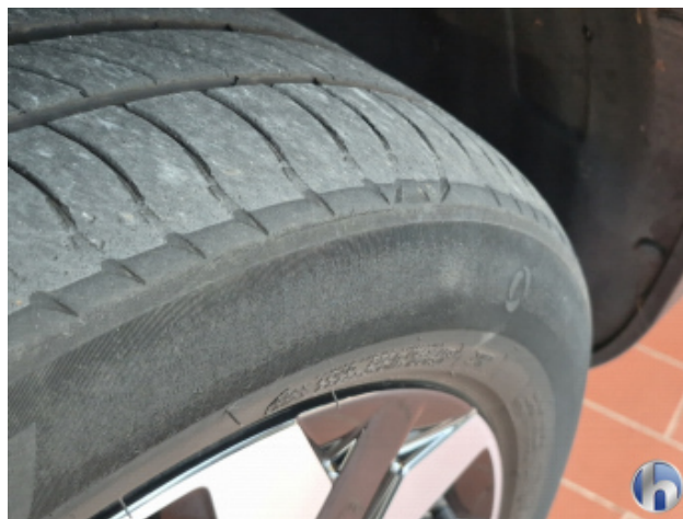
6. Reifen Vorne - Links Nicht Verkehrssicher - Erneuern
