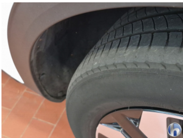
5. Reifen Vorne - Rechts Nicht Verkehrssicher - Erneuern
