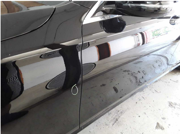
Beschädigung #2: Kotflügel links: Kotflügel links - Delle(n) - sanft instandsetzen
