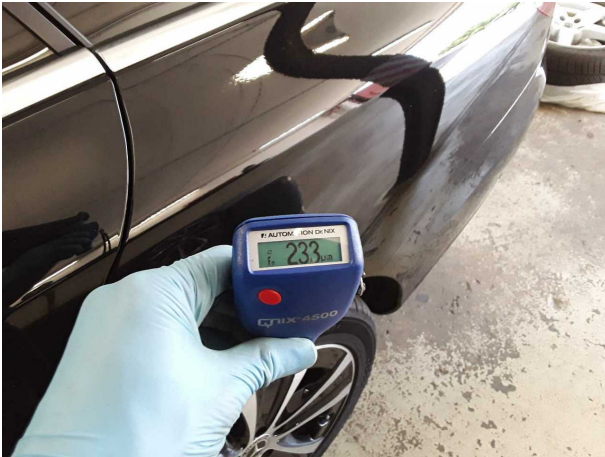
Nachlackierung 1: Seitenwand links, Tür hinten links, Tür vorne links
