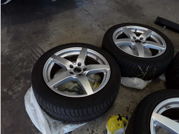
Beschädigung #1: 2.Radsatz: 2 Reifen (Seitlich abgefahren) - verschlissen - kein Abzug
