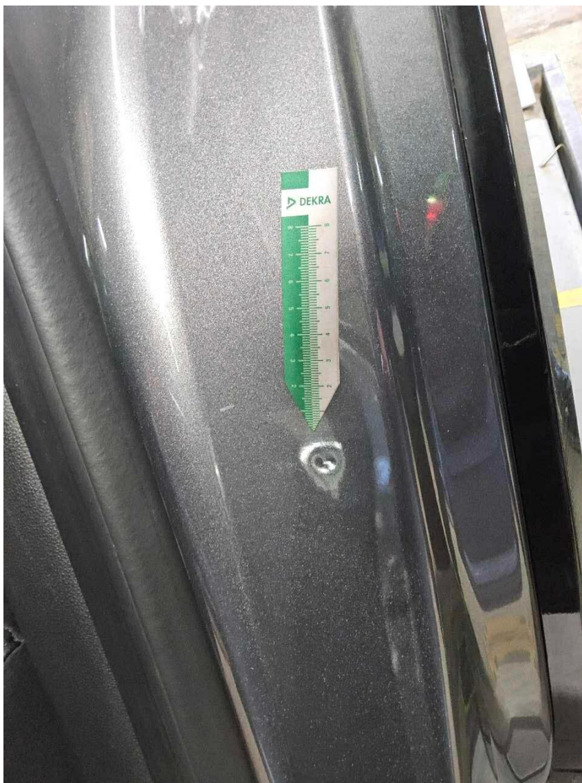
Bild 10 : Tür hinten links Einstieg, eingedellt, smart repair
