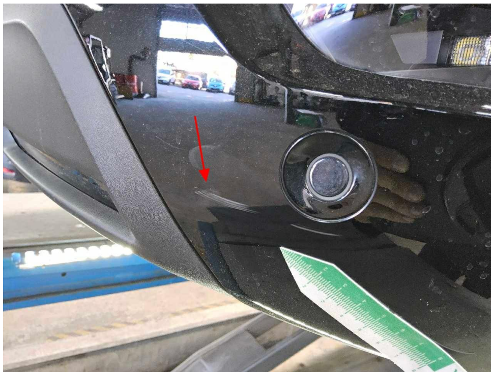
Bild 16 : Stoßfänger hinten Spoiler zerkratzt, Polierversuch Schadenerweiterung möglich
