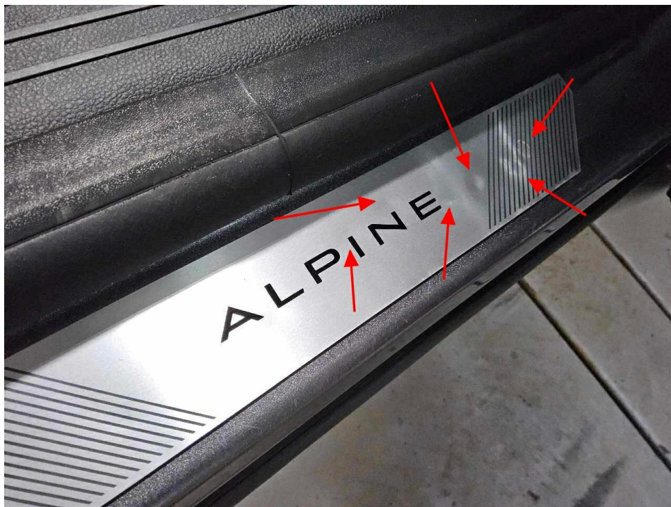
Bild 15 : Türeinstieg vorne rechts Zierleiste mehrfach eingedellt
