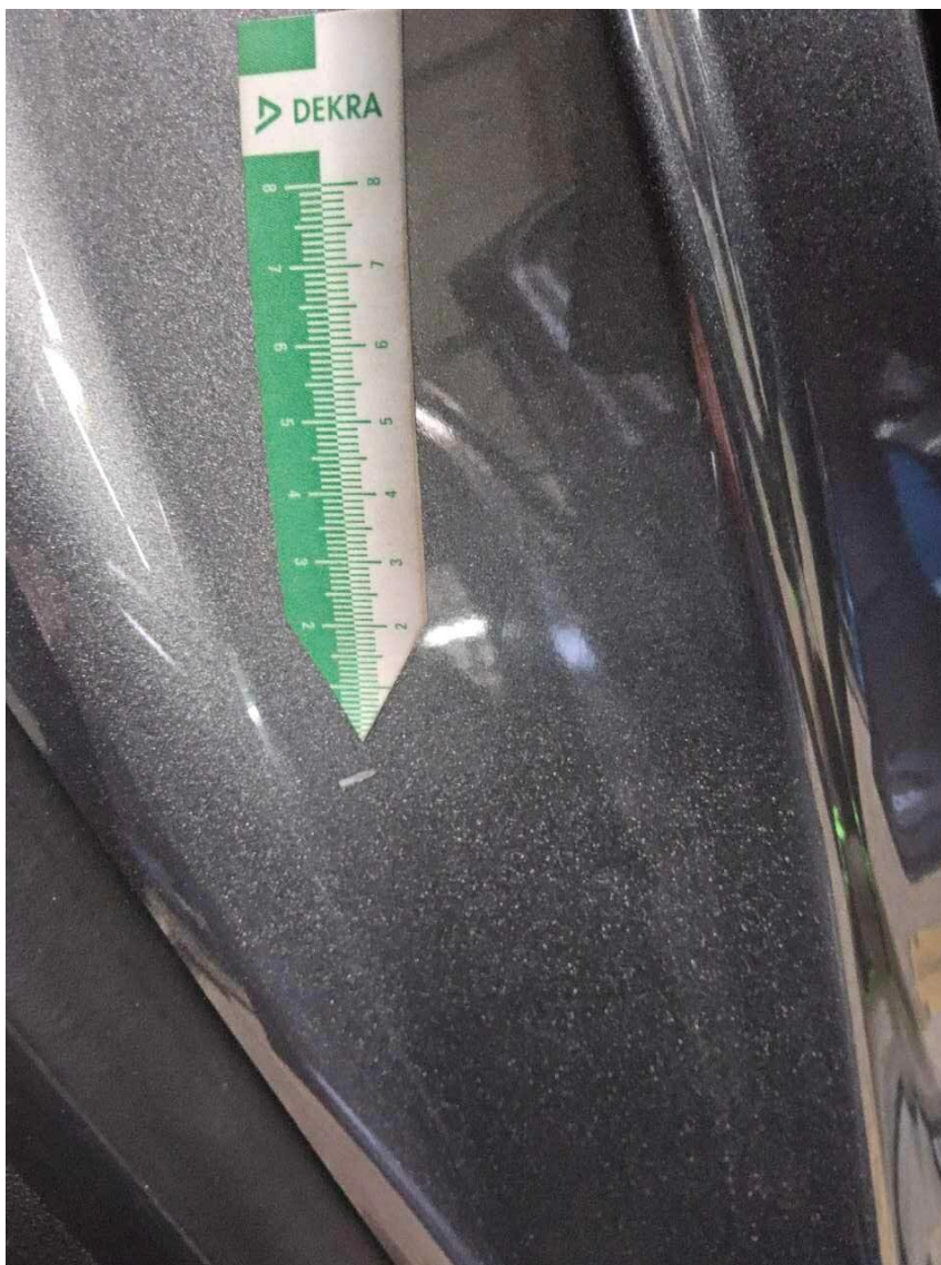
Bild 11 : Tür hinten links Einstieg, zerkratzt, smart repair
