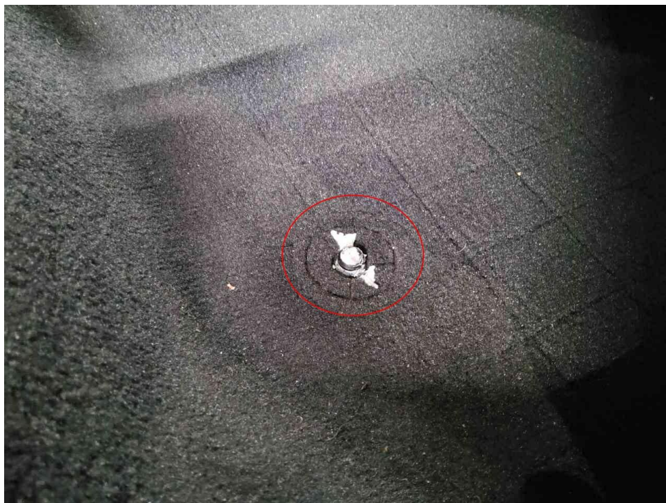
Bild 15 : Fußmattenbefestigung vorne rechts, nicht intakt
