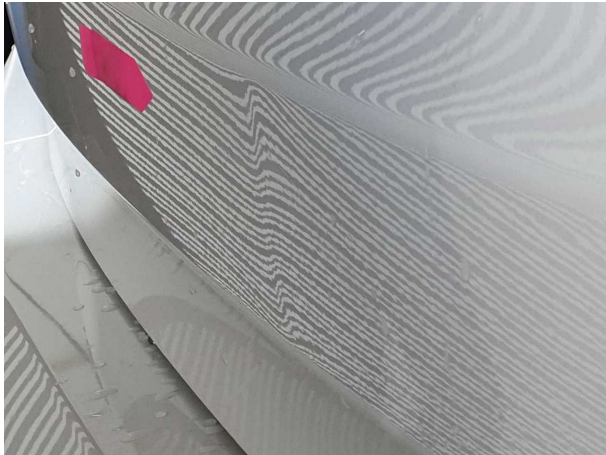
Beschädigung #3: Heckklappe/-tür: Heckklappe - Delle(n) - sanft instandsetzen
