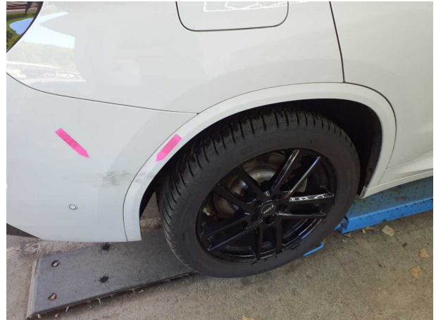
Beschädigung #4: Seitenwand rechts: Radlauf - beschädigt - erneuern
