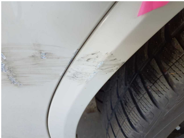
Beschädigung #4: Seitenwand rechts: Radlauf - beschädigt - erneuern
