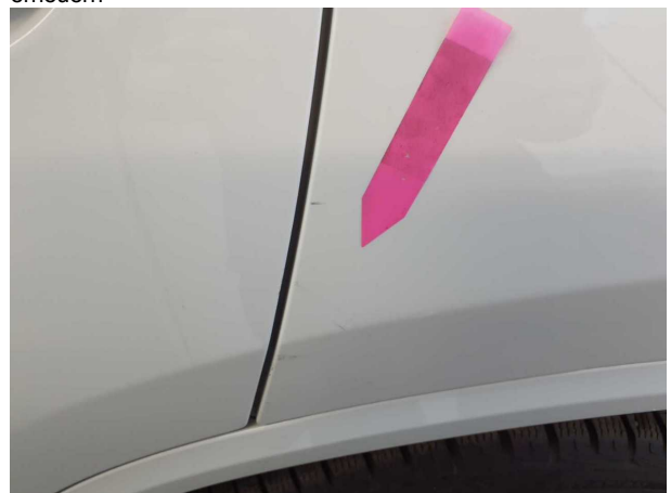
Beschädigung #2: Seitenwand links: Seitenwand (Polieren) - Abrieb - auslegen / polieren
