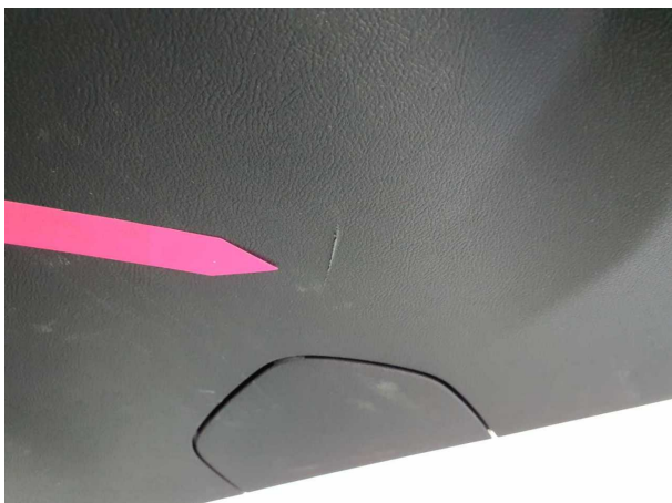
Beschädigung #5: Verkleidungen/Abdeckungen: Heckdeckel, Innenverkleidung - Kratzer - erneuern
