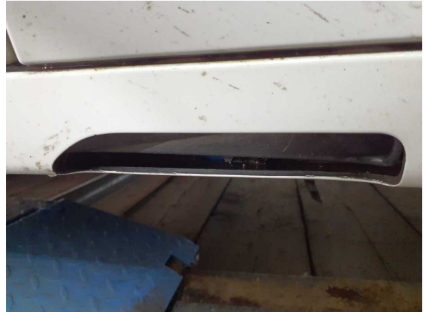
Beschädigung #1: Schweller rechts: Verkleidung (Blende) - fehlt - erneuern
