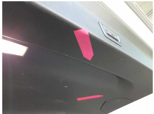
Beschädigung #5: Verkleidungen/Abdeckungen: Heckdeckel, Innenverkleidung - Kratzer - erneuern
