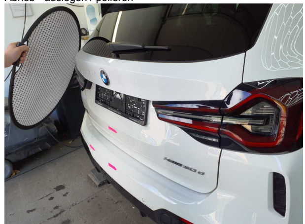
Beschädigung #3: Heckklappe/-tür: Heckklappe - Delle(n) - sanft instandsetzen
