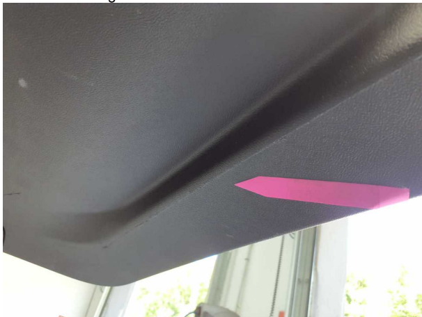
Beschädigung #5: Verkleidungen/Abdeckungen: Heckdeckel, Innenverkleidung - Kratzer - erneuern
