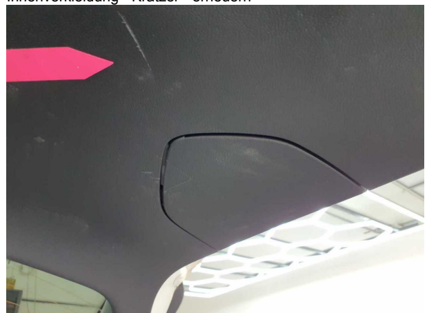
Beschädigung #5: Verkleidungen/Abdeckungen: Heckdeckel, Innenverkleidung - Kratzer - erneuern
