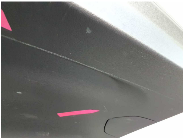
Beschädigung #5: Verkleidungen/Abdeckungen: Heckdeckel, Innenverkleidung - Kratzer - erneuern
