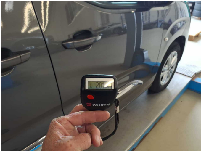
Door - front right side: 201 µm
