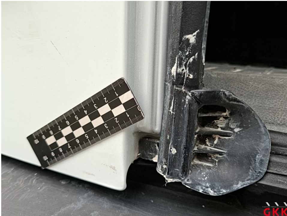
Bild 27 Hecktür links, Lackierung verätzt, aufbereiten
