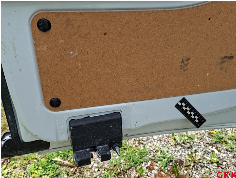
Bild 28 Hecktür links, Lackierung verätzt, aufbereiten
