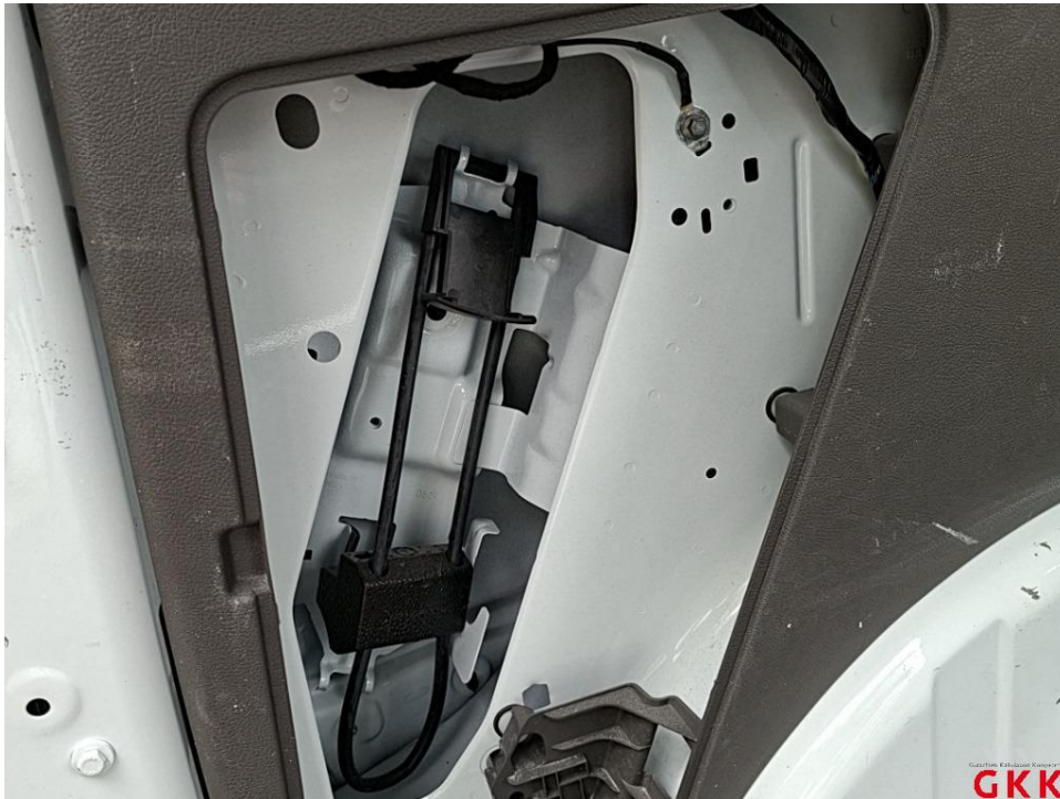
Bild 17 Reifenreparaturset, komplett, fehlt, ersetzen
