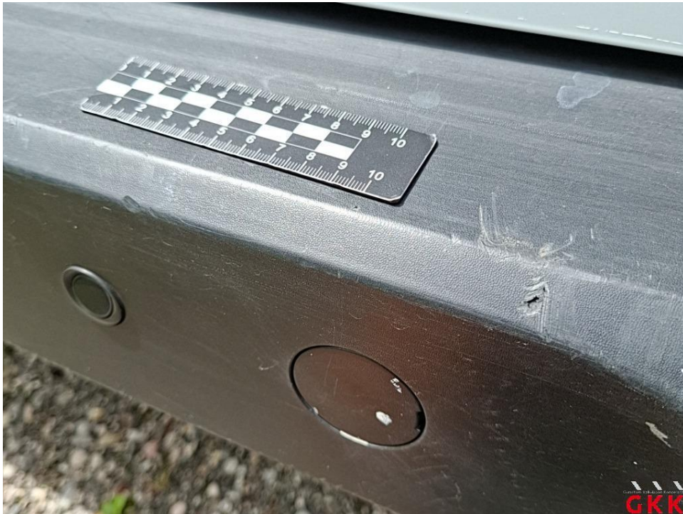
Bild 31 Stoßfänger hinten, Verkleidung unterhalb -unlackiert-, beschädigt, ersetzen
