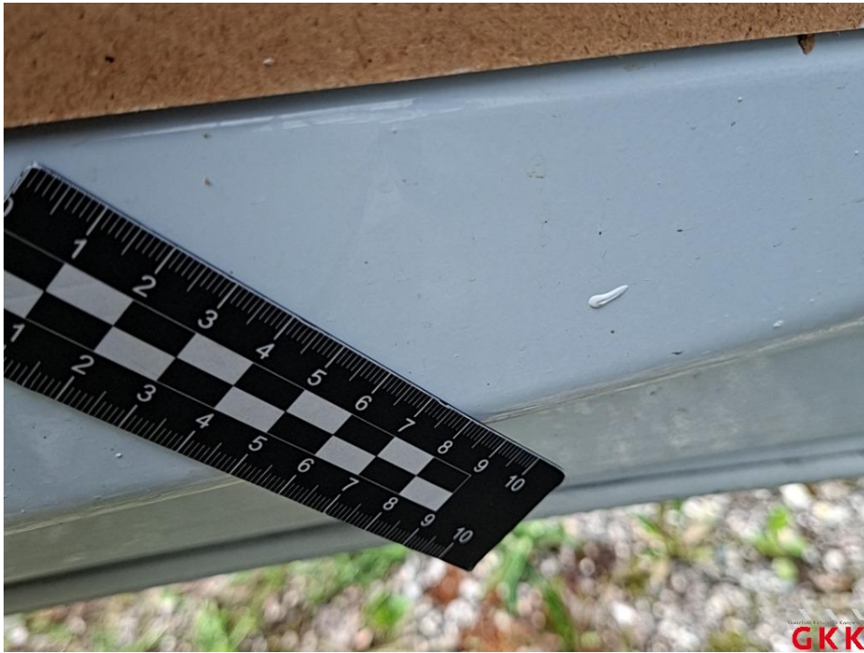
Bild 29 Hecktür links, Lackierung verätzt, aufbereiten
