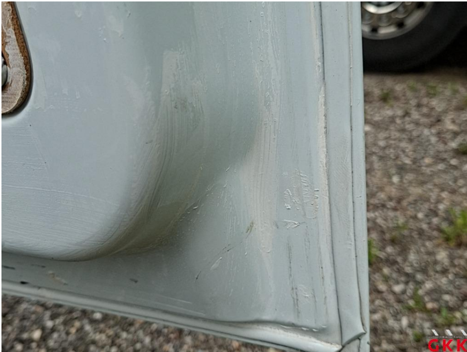
Bild 25 Hecktür rechts, Lackierung verätzt, aufbereiten
