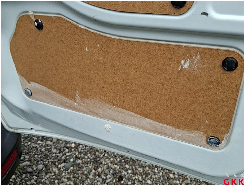
Bild 26 Hecktür rechts, Lackierung verätzt, aufbereiten
