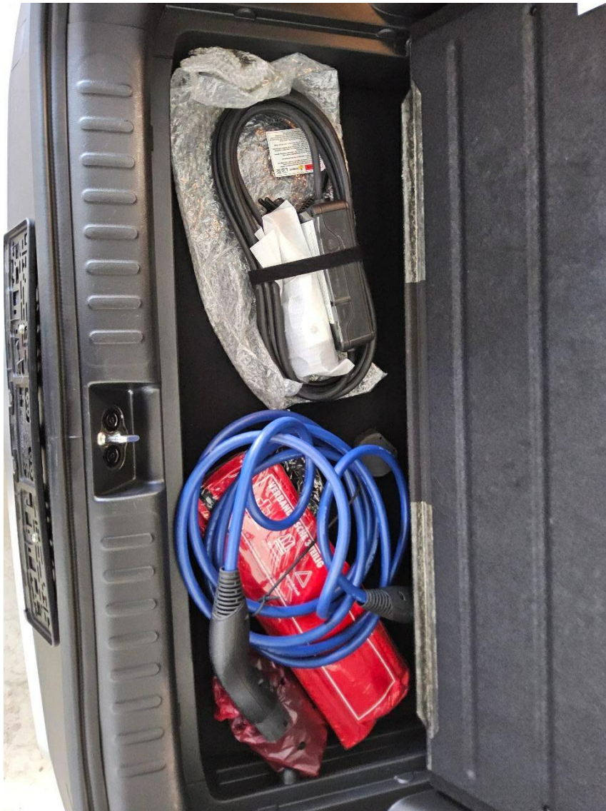
Bild 6 : Ladekabel beim E-Fahrzeug
