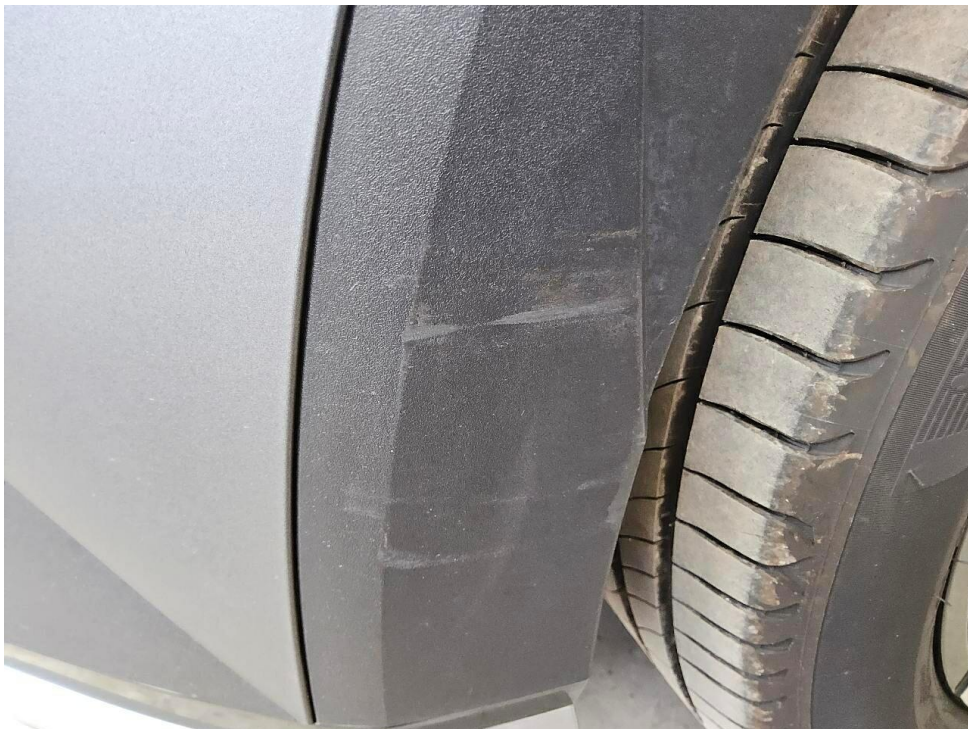
Bild 18 : Radlaufblende vorne links verkratzt
