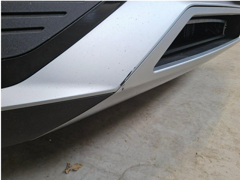
Bild 19 : Spoiler Stoßfänger vorne verschrammt
