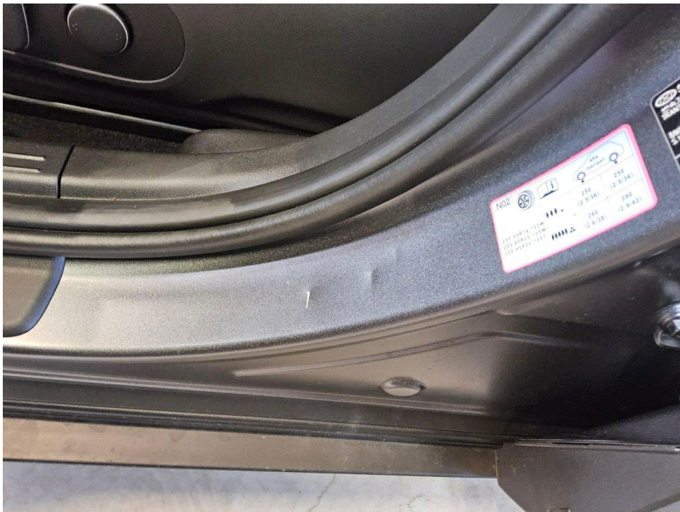
Bild 20 : Einstieg Fahrtür verschrammt und eingedellt
