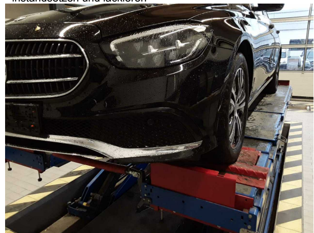
Beschädigung 5: Stossfänger vorn: Stossfänger vorn (Inkl. Blende) - verkratzt / verschürft - lackieren
