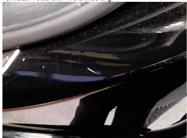
Beschädigung 3: Seitenwand links: Einstieg - verkratzt / verschürft - lackieren
