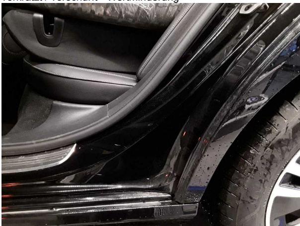
Beschädigung 3: Seitenwand links: Einstieg - verkratzt / versch... - lackieren
