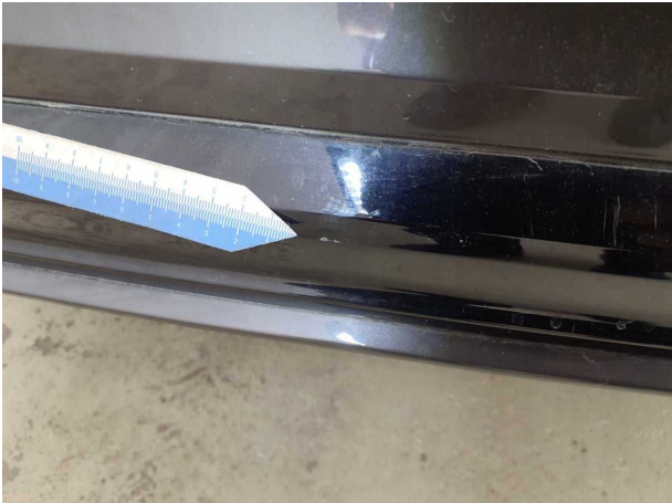
Beschädigung #6: Stossfänger hinten: Spoiler - Kratzer - Smart Repair
