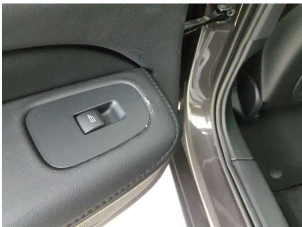
Beschädigung #5: Verkleidungen/Abdeckungen: Türverkleidung hint... links - porös / rissig - Smart Repair
