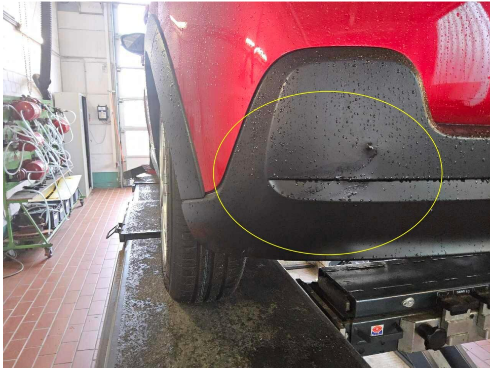
Bild 13 : Stoßfänger hinten deformiert
