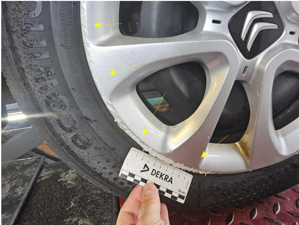
Bild 17 : Radzierblende vorne rechts zerkratzt
