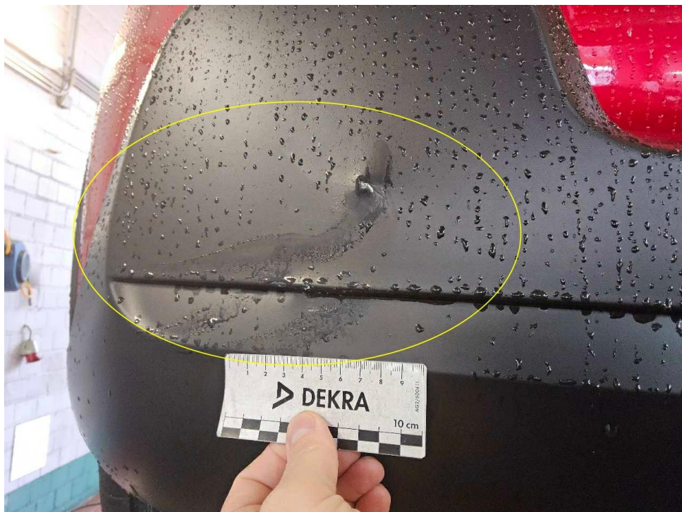
Bild 14 : Stoßfänger hinten deformiert
