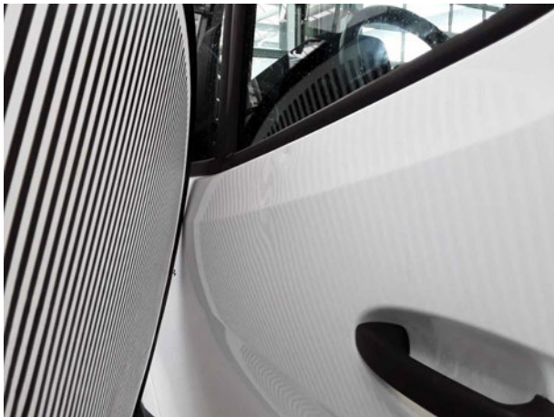
Beschädigung #11: Tür vorn links: Tür - verformt - erneuern
