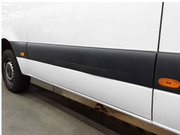
Beschädigung #4: Schiebetür rechts: Schutzleiste (Verformt) - verkratzt / verschürft - erneuern
