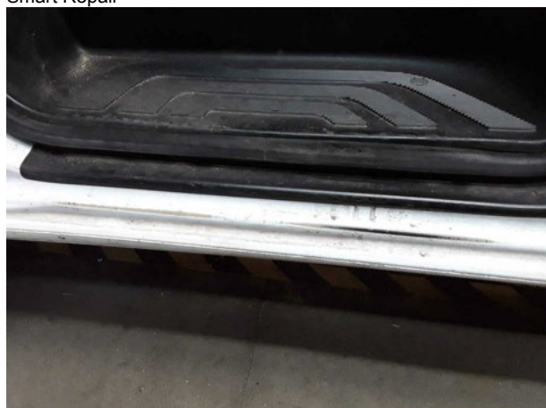
Beschädigung #7: Schweller links: Einstieg - verkratzt / verschürft - lackieren
