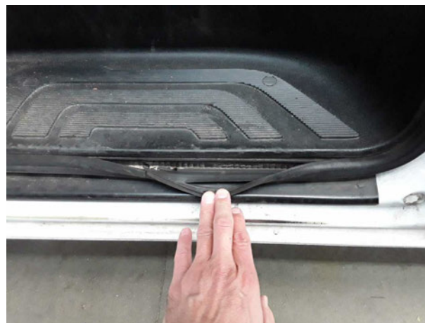
Beschädigung #2: Tür vorn links: Türdichtung - gebrochen / gerissen - erneuern
