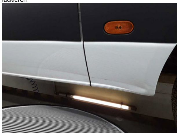
Beschädigung #9: Seitenwand links: Seitenwand (Unterhalb) - Delle / Lackschaden - instandsetzen und lackieren
