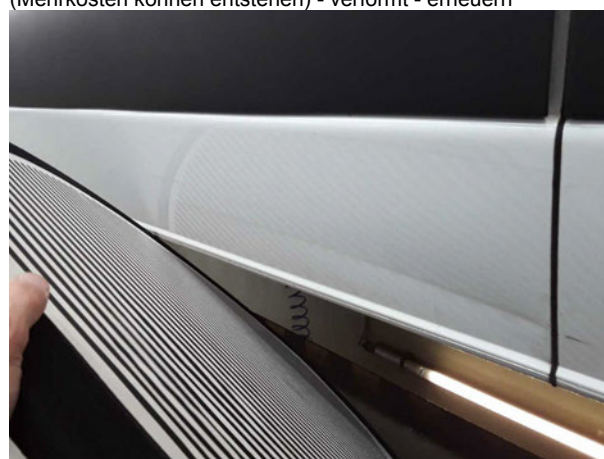
Beschädigung #9: Seitenwand links: Seitenwand (Unterhalb) - Delle / Lackschaden - instandsetzen und lackieren
