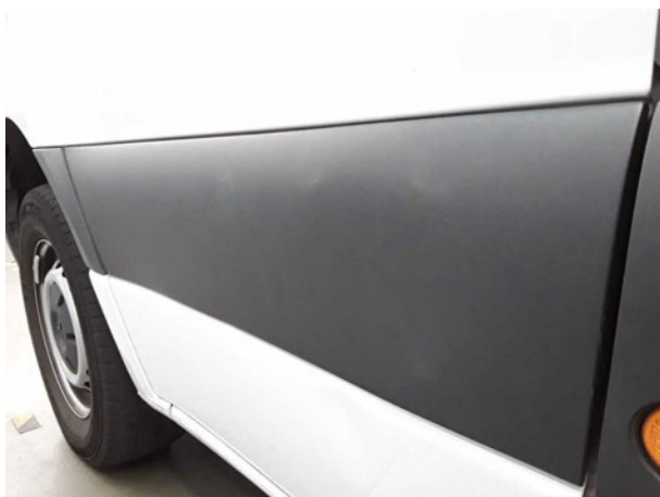
Beschädigung #3: Tür vorn links: Zierleiste unten - verformt - erneuern
