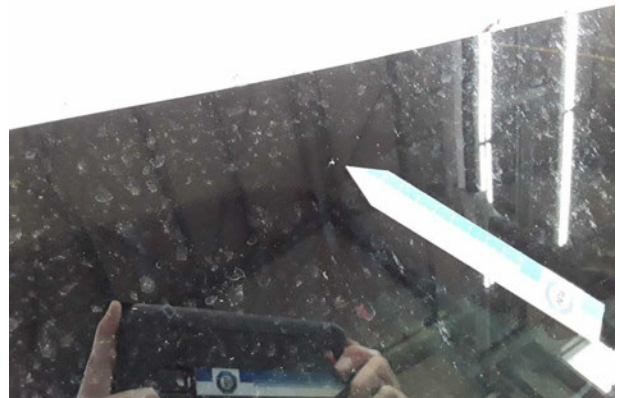
Beschädigung #10: Verglasung: Frontscheibe mit Spurhalteassistent - Steinschlag - erneuern
