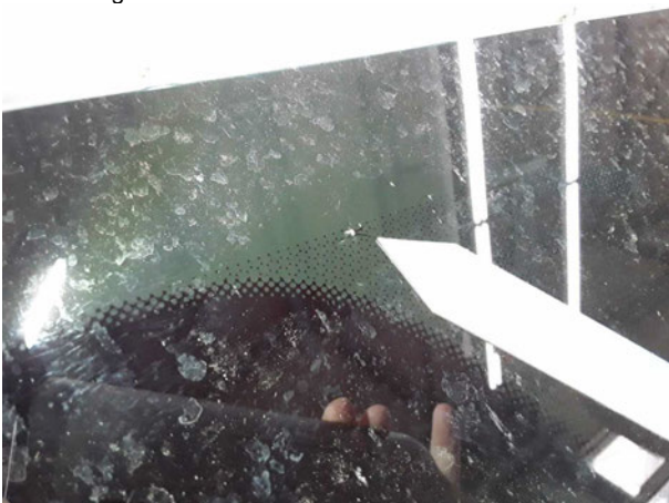
Beschädigung #10: Verglasung: Frontscheibe mit Spurhalteassistent - Steinschlag - erneuern
