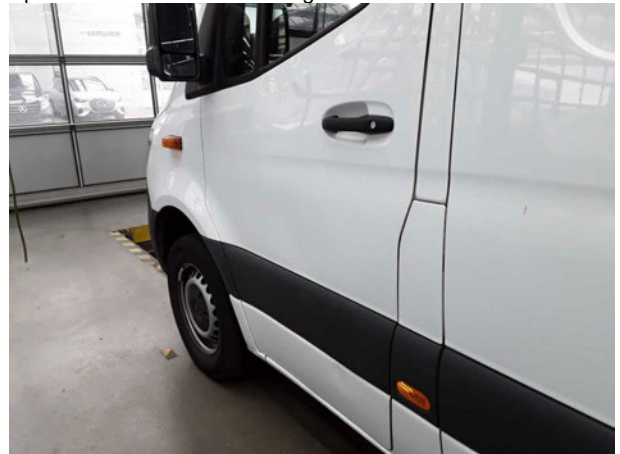
Beschädigung #11: Tür vorn links: Tür - verformt - erneuern
