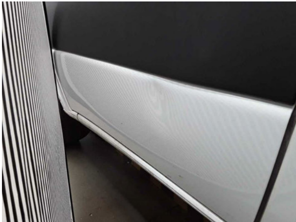
Beschädigung #11: Tür vorn links: Tür - verformt - erneuern
