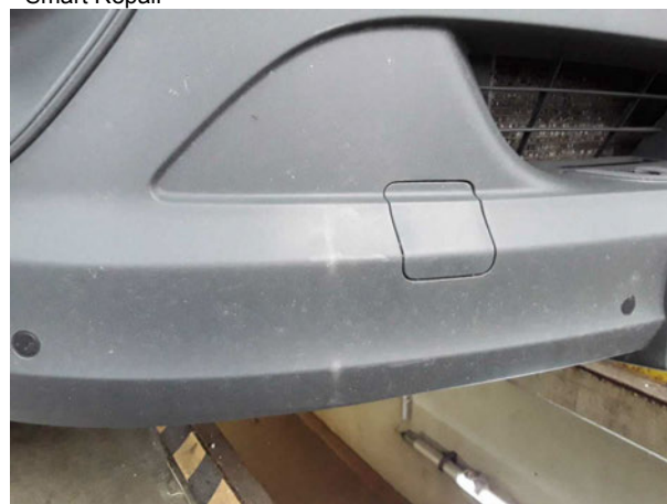
Beschädigung #8: Stossfänger vorn: Stossfänger mit Parktronic (Mehrkosten können entstehen) - verformt - erneuern
