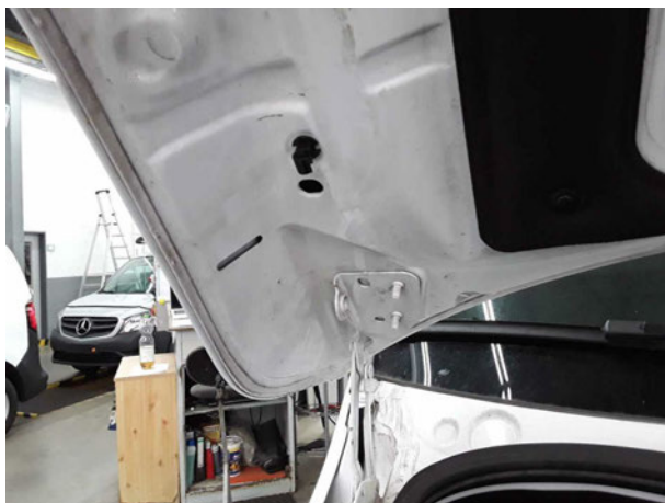
Beschädigung #1: Motorhaube: Stütze - fehlt - erneuern
