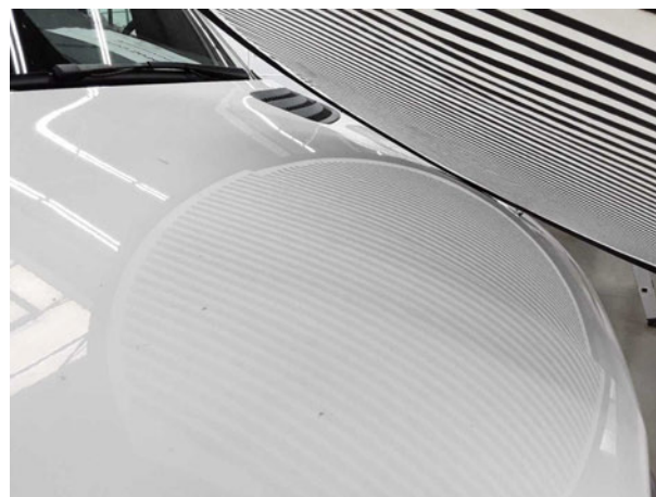
Beschädigung #6: Motorhaube: Motorhaube - Delle / Lackschad... - Smart Repair
