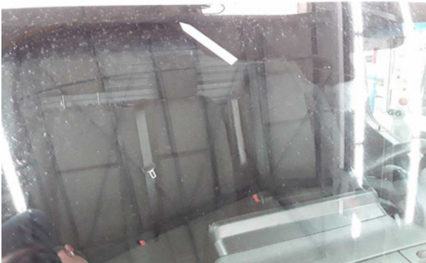
Beschädigung #10: Verglasung: Frontscheibe mit Spurhalteassistent - Steinschlag - erneuern
