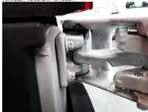
Beschädigung #5: Heckklappe/-tür: Scharnier unten (270 Grad) (Rechts) - verformt - erneuern
