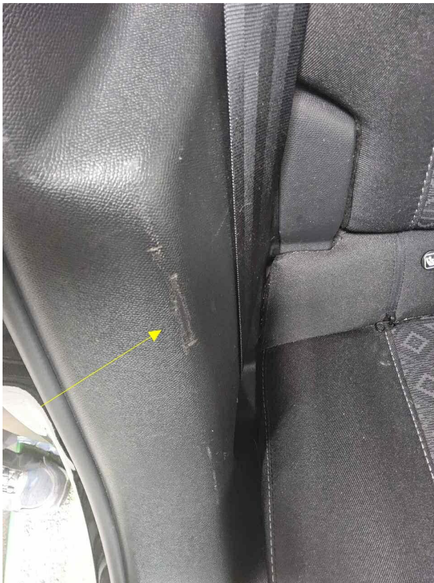
Bild 13 : Verkleidung Einstieg hinten rechts leicht verkratzt
