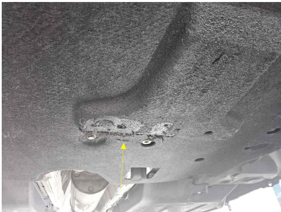
Bild 22 : Unterbodenverkleidung vorn leicht verschrammt
