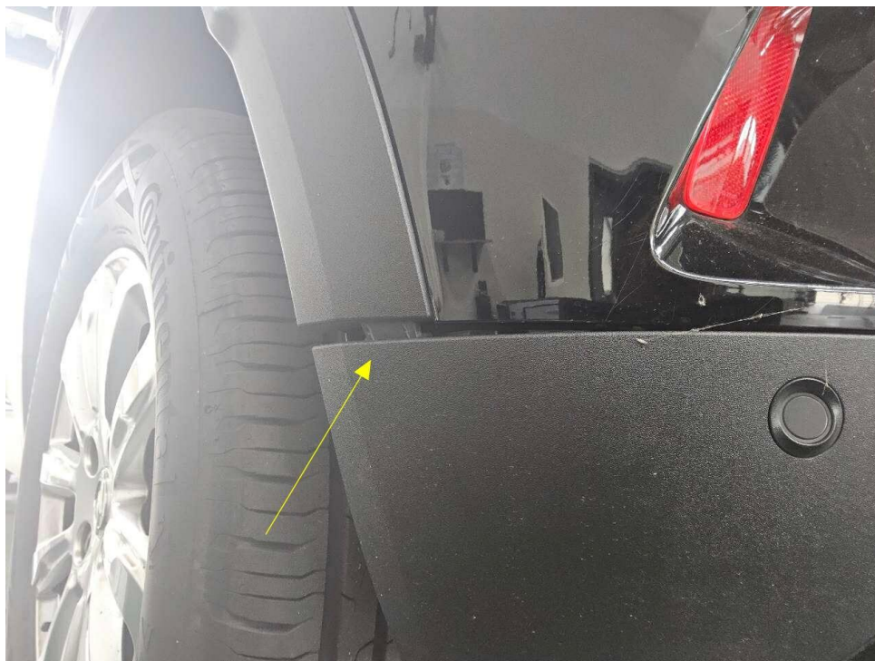
Bild 18 : Unfallschaden hinten links
