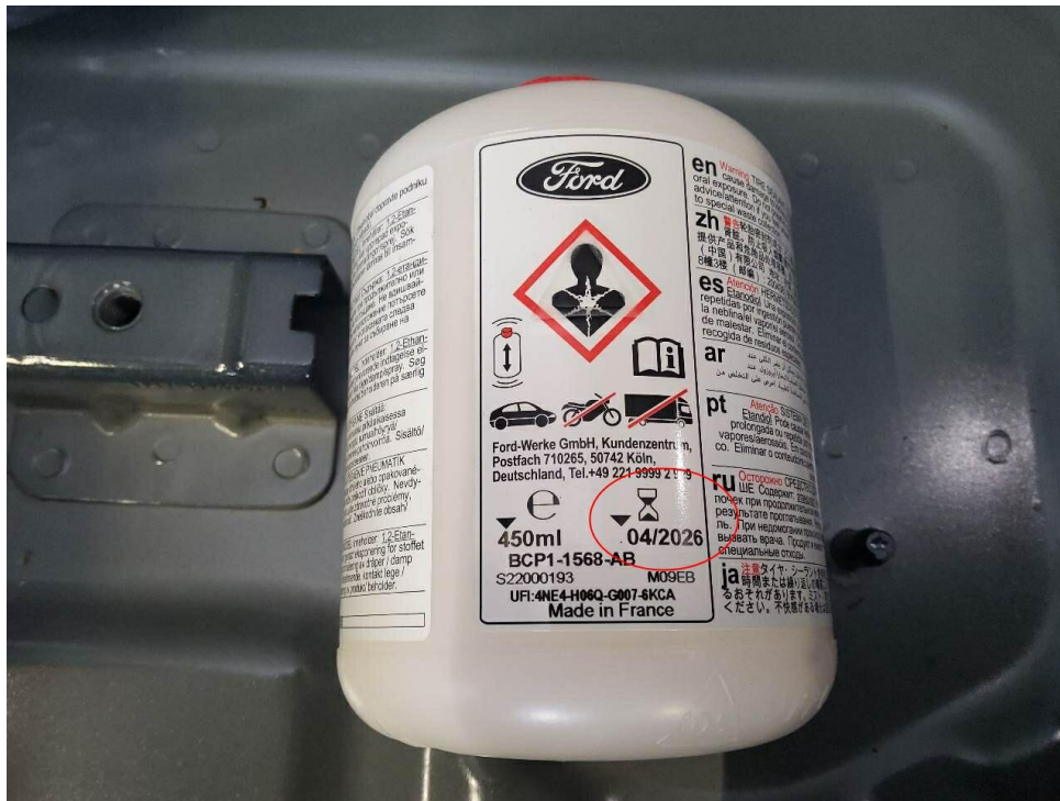
Bild 13 : Füllflasche Pannenset, abgelaufen (06/2026)
