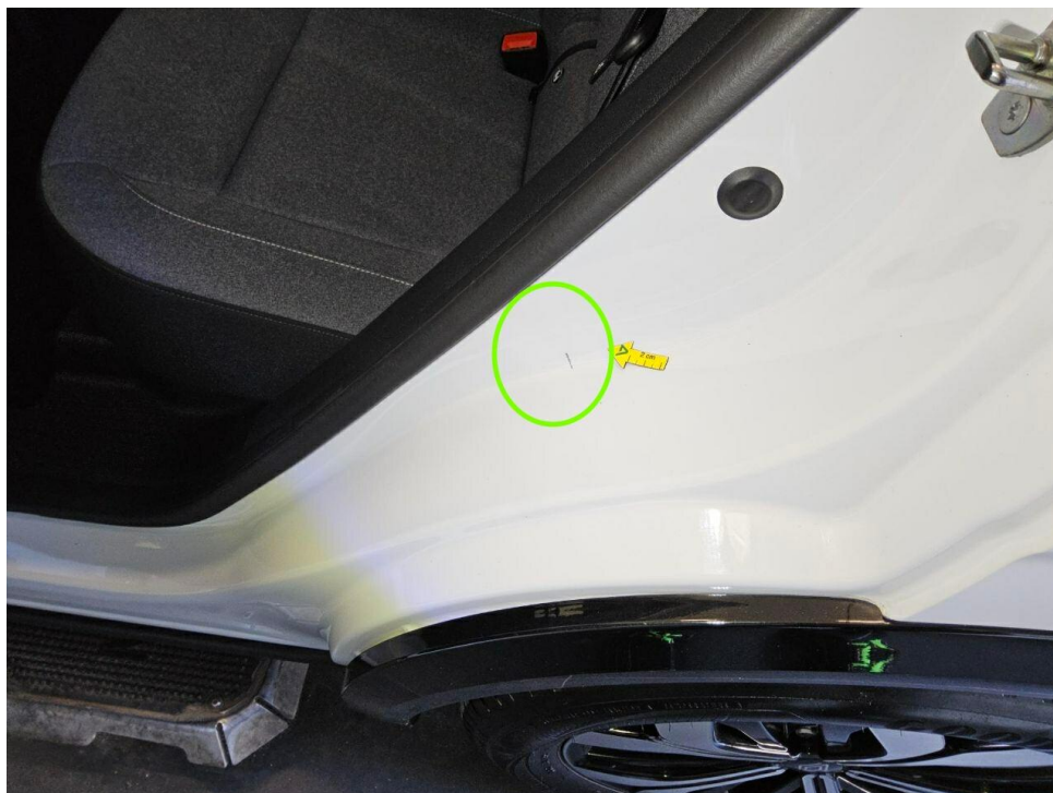
Bild 14 : Tür hinten links Einstieg Lackierung, zerkratzt, smart repair
