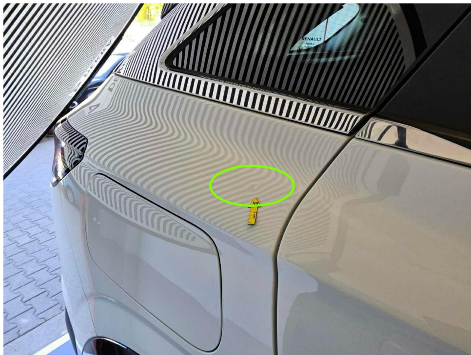
Bild 17 : Seitenteil hinten rechts, eingedellt, drücken
