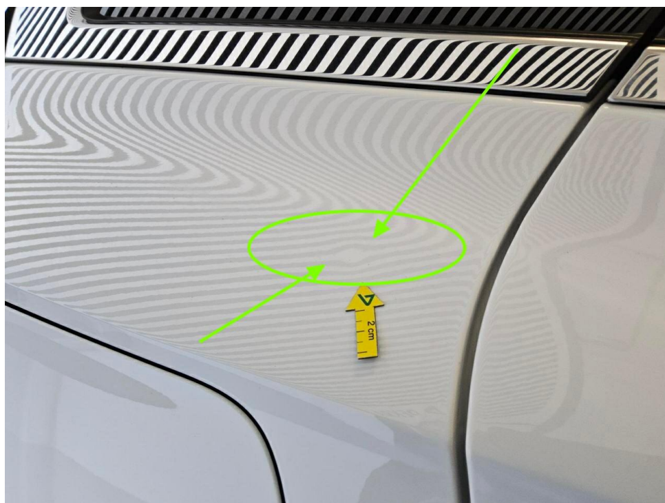
Bild 18 : Seitenteil hinten rechts, eingedellt, drücken
