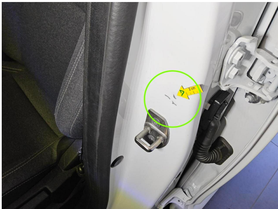
Bild 16 : Tür vorne links Einstieg Lackierung, zerkratzt, smart repair
