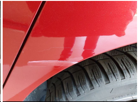
Kotflügel / Hinten Links / Kratzer
