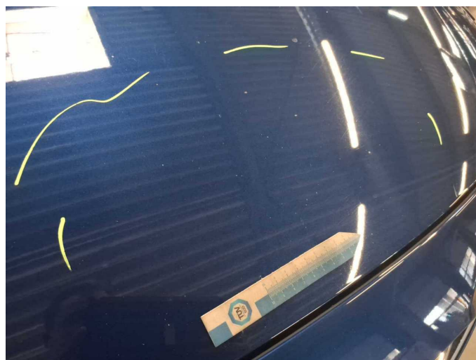
Damage 6: Bonnet: Bonnet (Sandstrahleffekt) - Stone chips - Paint
