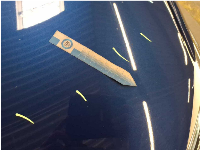
Damage 6: Bonnet: Bonnet (Sandstrahleffekt) - Stone chips - Paint
