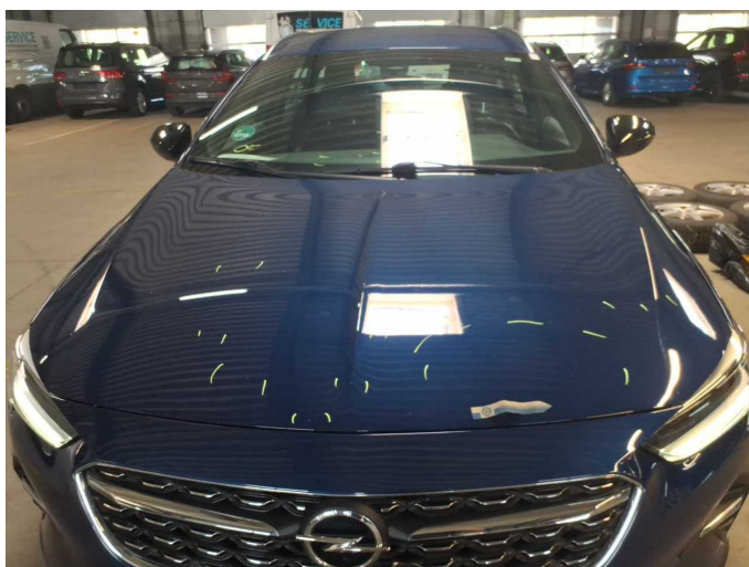
Damage 6: Bonnet: Bonnet (Sandstrahleffekt) - Stone chips - Paint
