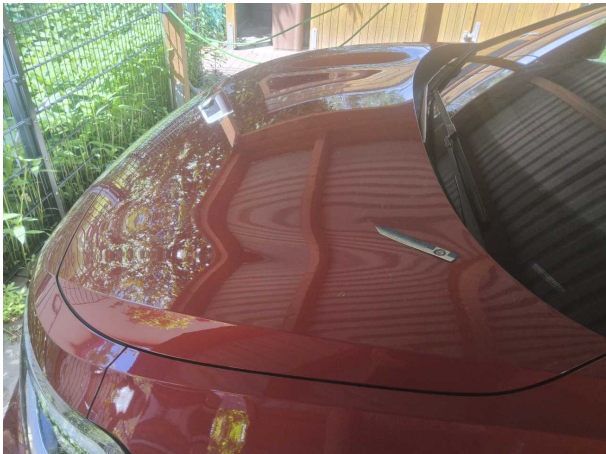
Beschädigung 1: Motorhaube: Motorhaube - Delle(n) - sanft instandsetzen
