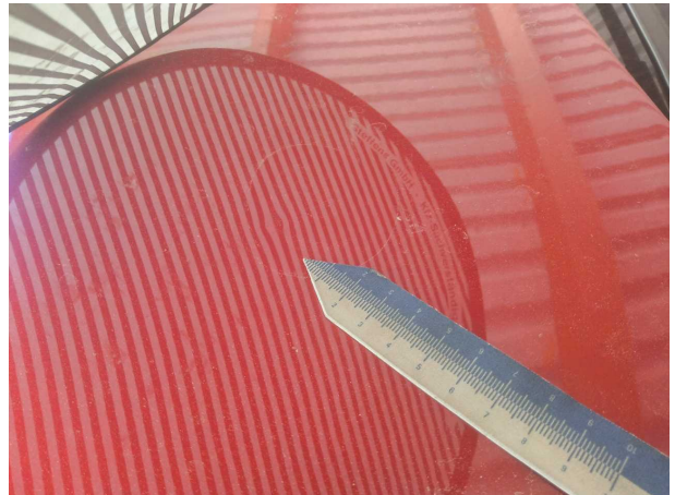
Beschädigung 1: Motorhaube: Motorhaube - Delle(n) - sanft instandsetzen
