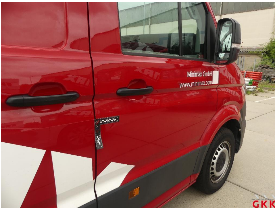
Bild 16. Tür vorne rechts, verkratzt, auslegen, schleifen, polieren
