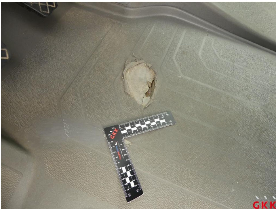
Bild 26. Teppich, vorne links, beschädigt, ersetzen
