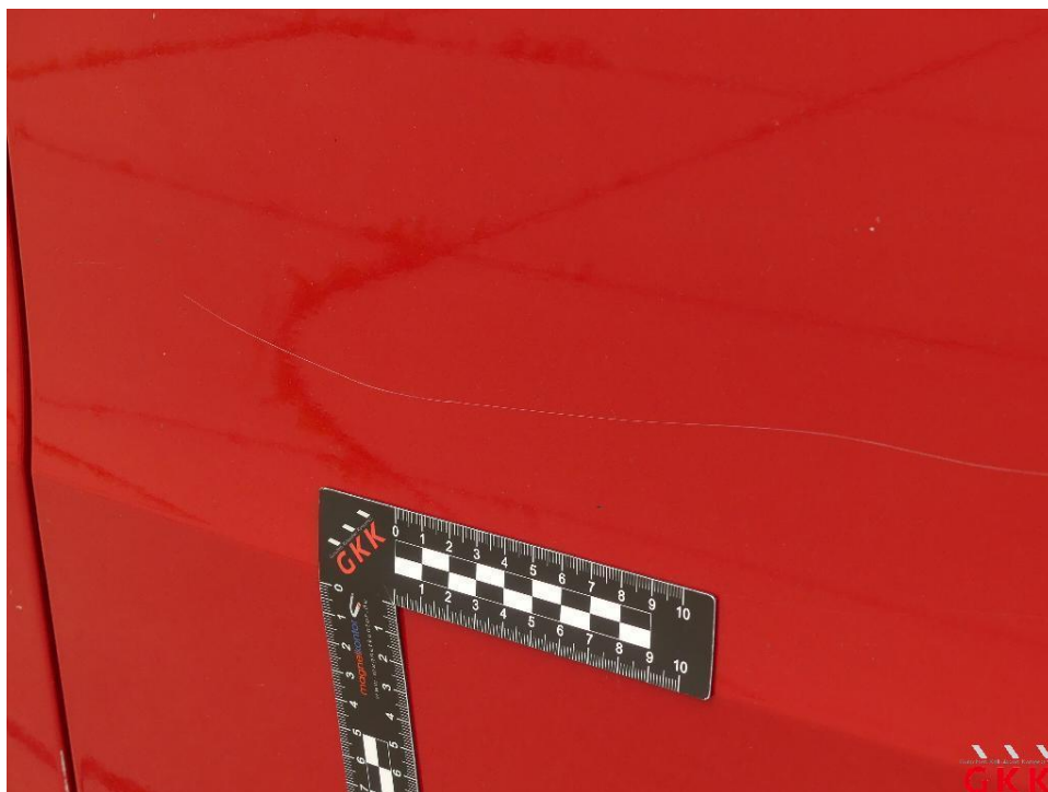
Bild 22. Hecktür rechts, verkratzt, lackieren
