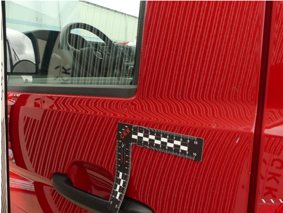
Bild 19. Tür vorne links, beschädigt, instand setzen - lackieren
