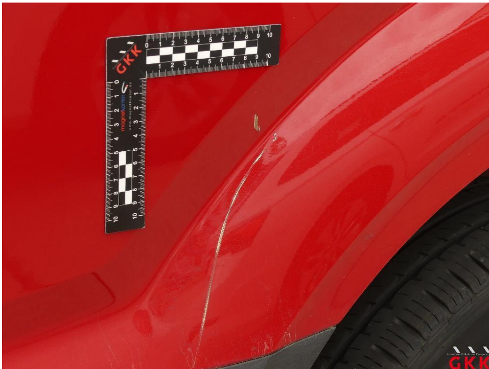
Bild 15. Seitenwand rechts, verkratzt, lackieren
