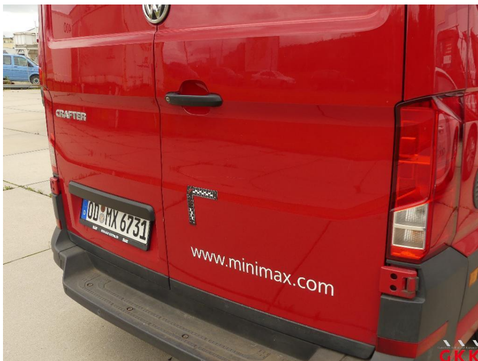
Bild 21. Hecktür rechts, verkratzt, lackieren
