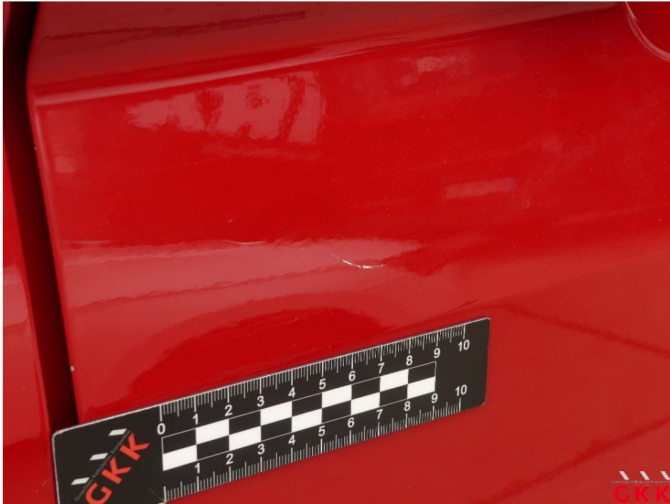
Bild 17. Tür vorne rechts, verkratzt, auslegen, schleifen, polieren
