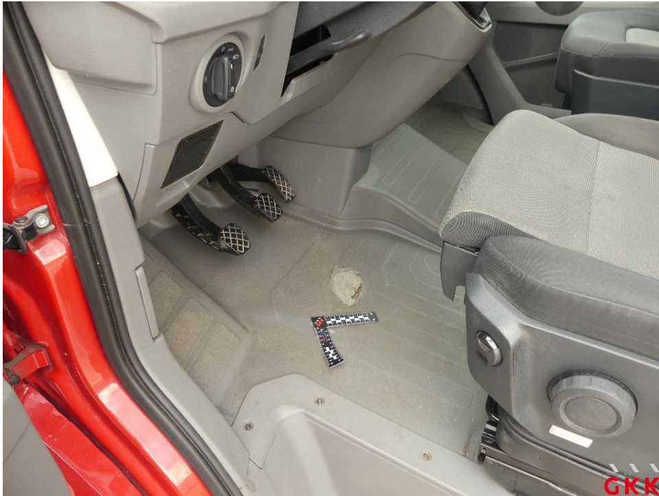
Bild 25. Teppich, vorne links, beschädigt, ersetzen
