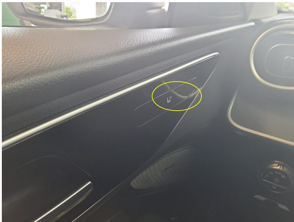
Bild 13 : Sitzheizung vorn links, schaltet selbstständig ab - Werkstattbefund nötig
