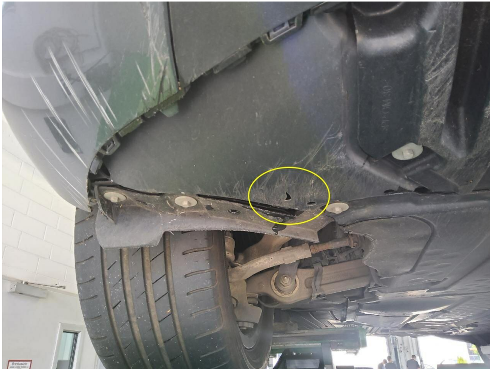
Bild 37 : Unterfahrschutz vorn rechts gebrochen
