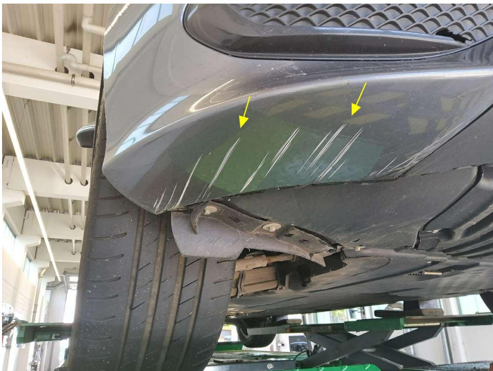
Bild 38 : Stoßfänger vorn, unterhalb verschrammt
