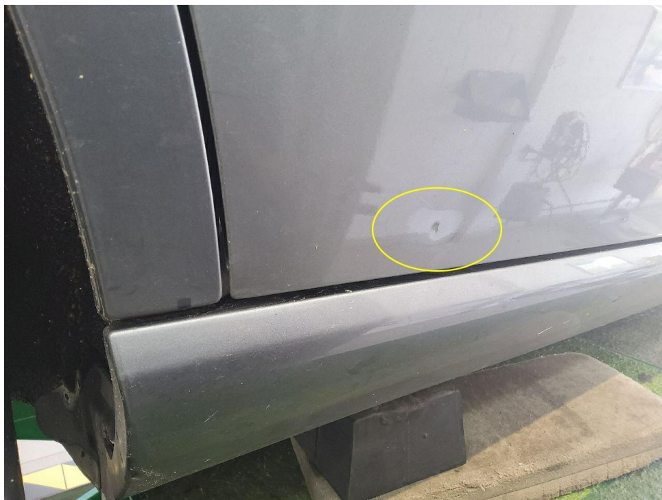
Bild 35 : Tür hinten links, verdellt und verschrammt
