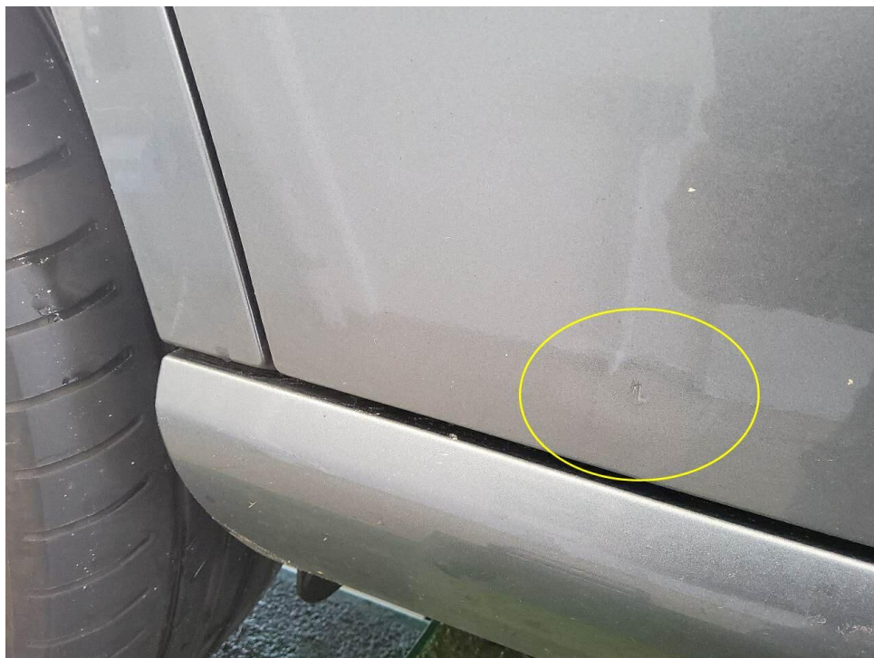
Bild 36 : Tür hinten links, verdellt und verschrammt
