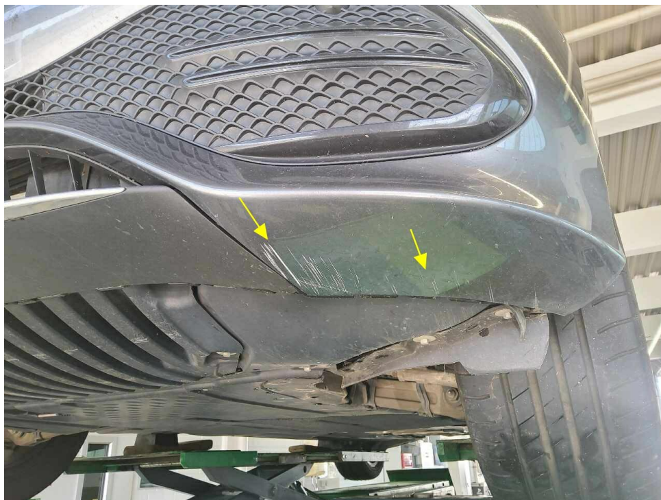
Bild 39 : Stoßfänger vorn, unterhalb verschrammt
