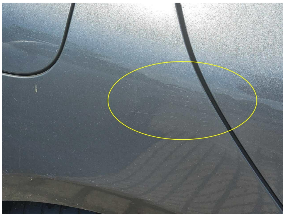
Bild 41 : Seitenteil hinten rechts, verschrammt
