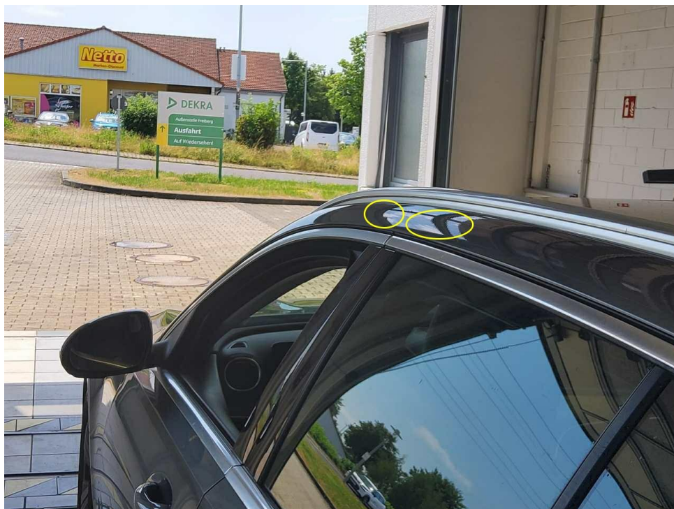
Bild 29 : Dachholm links, Dellen
