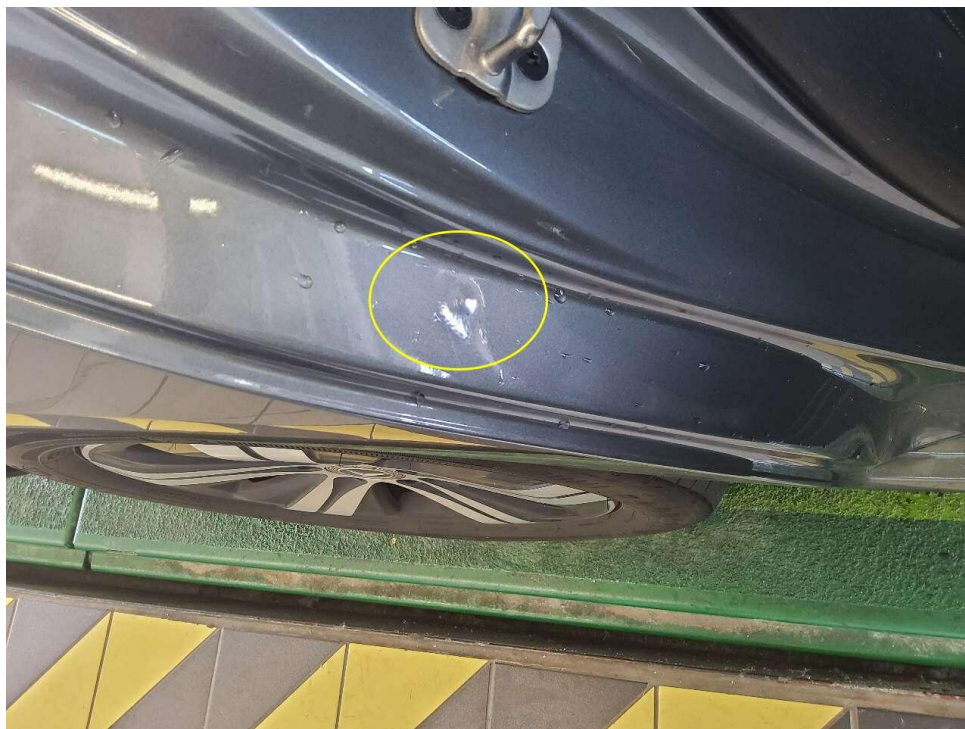
Bild 31 : Einstieg hinten rechts, Delle
