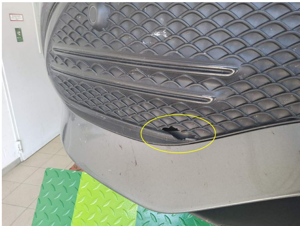
Bild 32 : Stoßfänger vorn, Blende rechts, gebrochen
