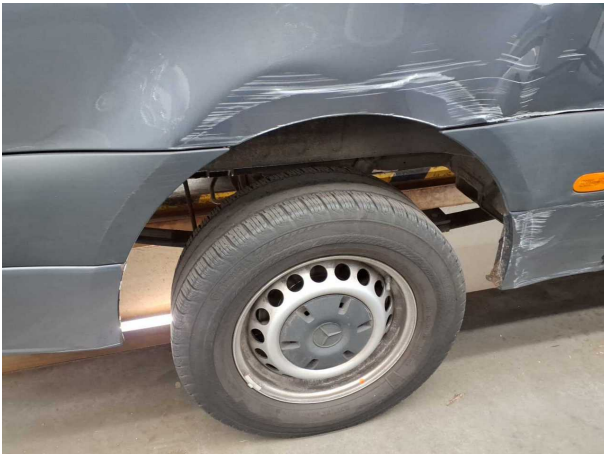
Beschädigung #6: Festpreis: Reifen 235/65 R16C (HR) - verschlissen - erneuern
