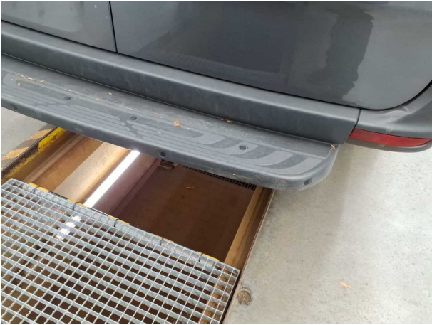
Beschädigung #8: Stossfänger hinten: Verkl. Stossfänger Auftritt mit Parktronic - verformt - erneuern
