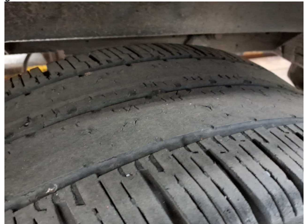
Beschädigung #6: Festpreis: Reifen 235/65 R16C (HR) - verschlissen - erneuern
