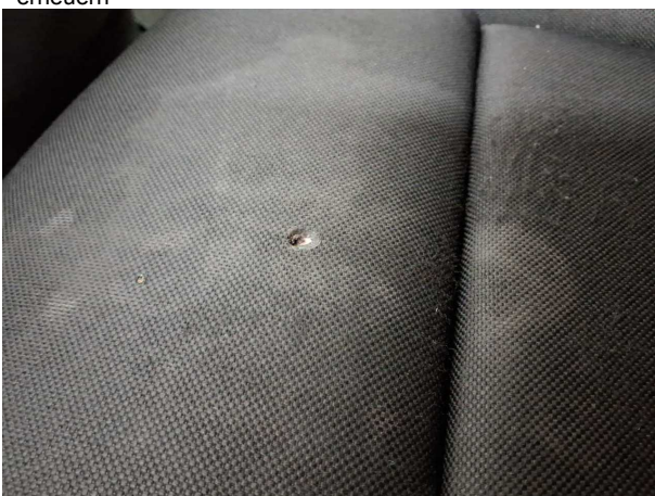
Beschädigung #7: Sitz vorn: Sitzbezug links - Brandloch - erneuern
