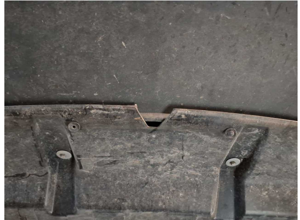
Beschädigung #5: Motor: Motorverkleidung unten - gebrochen / gerissen - erneuern
