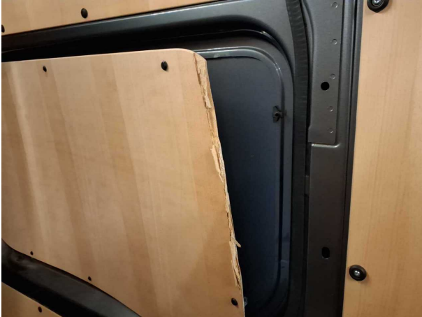
Beschädigung #1: Schiebetür rechts: Verkleidung Sperrholz Mitte - gebrochen / gerissen - erneuern
