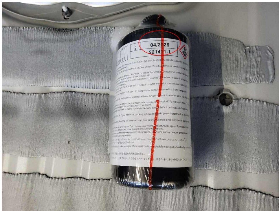
Bild 16 : Füllflasche Pannenset, abgelaufen (04/2026)
