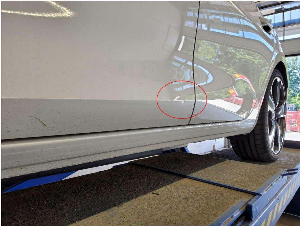
Bild 17 : Tür vorne links, eingedellt
