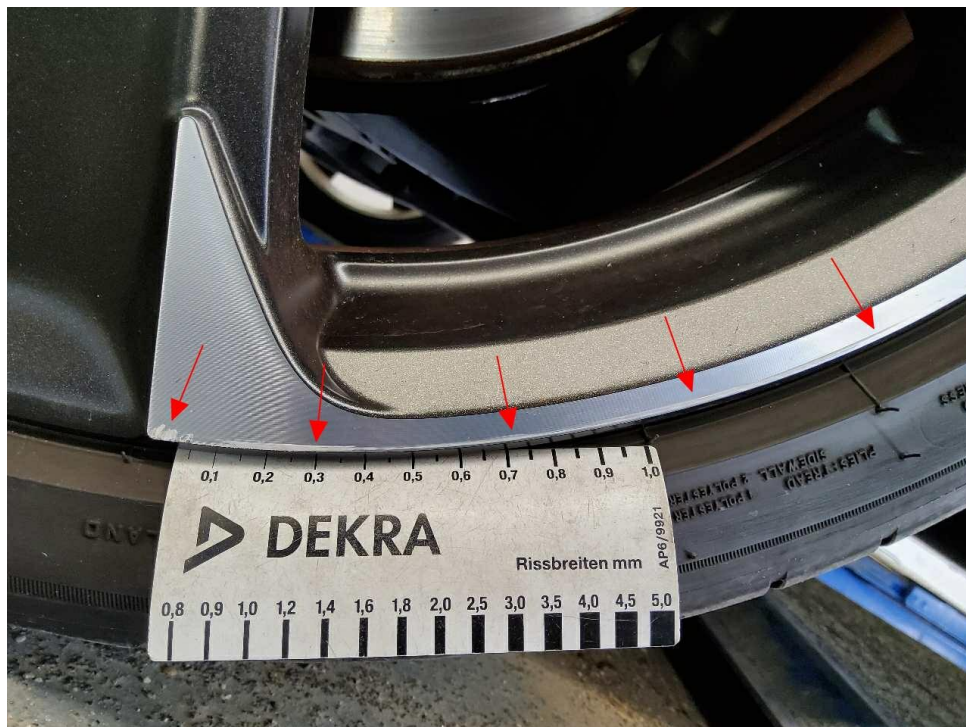
Bild 20 : LM-Felge vorne links, glanzgedreht, verschrammt
