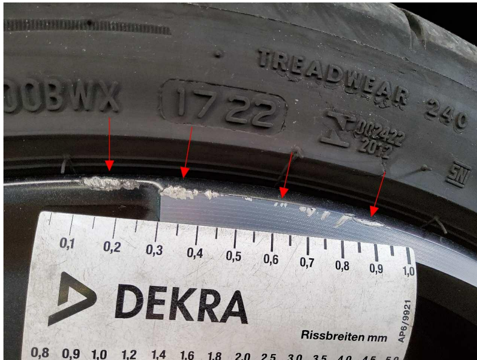
Bild 19 : LM-Felge vorne links, glanzgedreht, verschrammt
